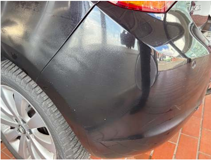
Stoßstange hinten (Unsachgemäß instand gesetzt, Kratzer, Riss/Bruch)
