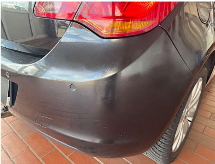
Stoßstange hinten (Unsachgemäß instand gesetzt, Kratzer, Riss/Bruch)
