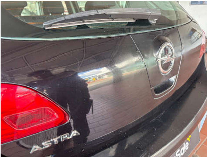
Heckklappe (Kratzer, Unsachgemäß instand gesetzt)
