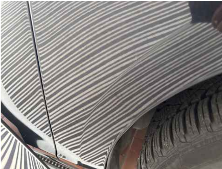
Kotflügel vorne rechts (Delle, Kratzer)
