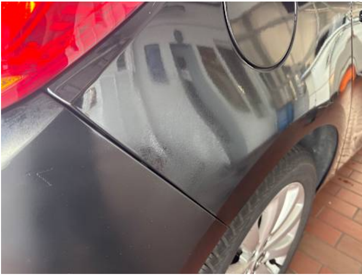
Seitenteil hinten rechts (Delle, Unsachgemäß instand gesetzt)
