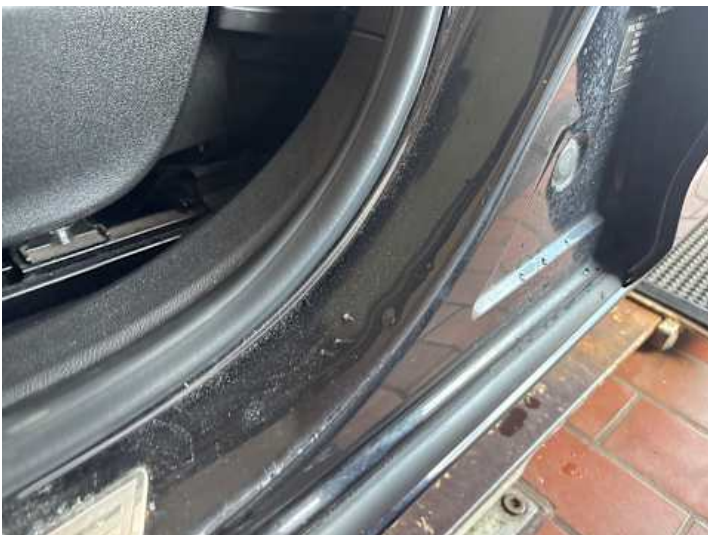
Schweller links (Kratzer, Delle, Rost)
