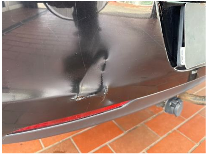
Stoßstange hinten (Unsachgemäß instand gesetzt, Kratzer, Riss/Bruch)
