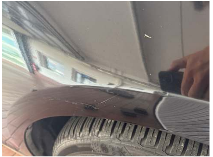
Kotflügel vorne rechts (Delle, Kratzer)
