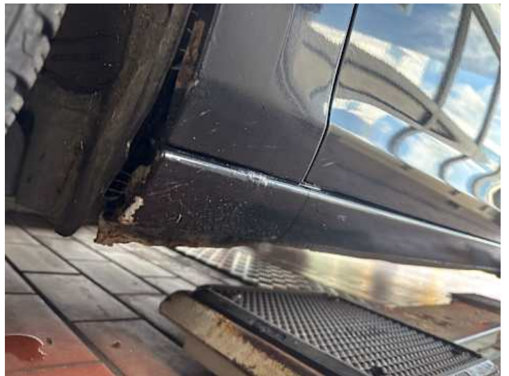
Schweller links (Kratzer, Delle, Rost)
