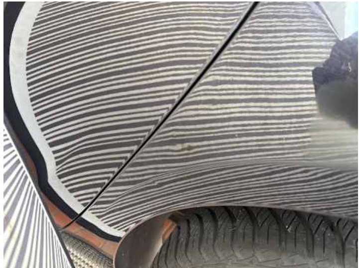
Seitenteil hinten links (Unsachgemäß instand gesetzt, Kratzer, Lackschaden, Delle)
