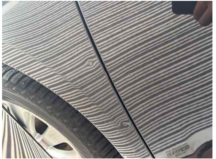
Seitenteil hinten rechts (Delle, Unsachgemäß instand gesetzt)
