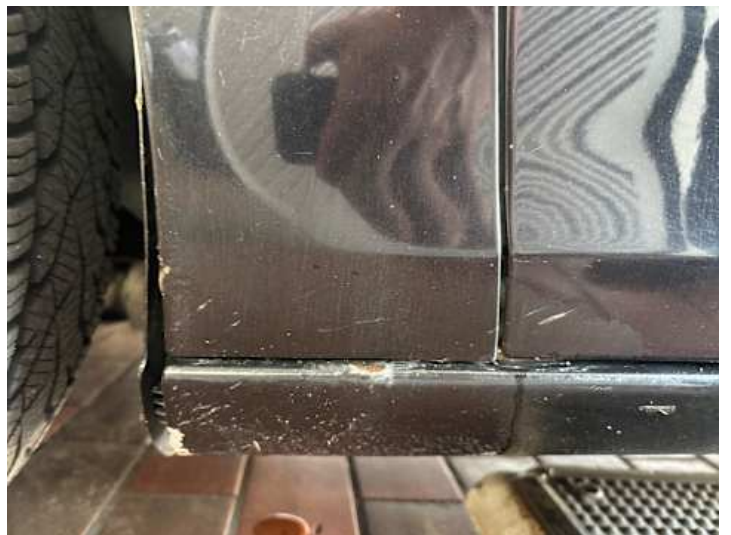
Kotflügel vorne links (Kratzer, Rost)
