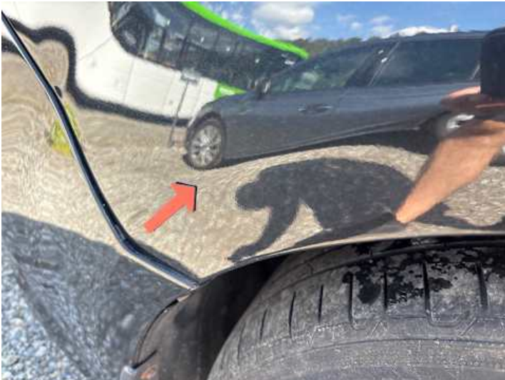
Seitenteil hinten rechts (Ausgeblichen/Matt)
