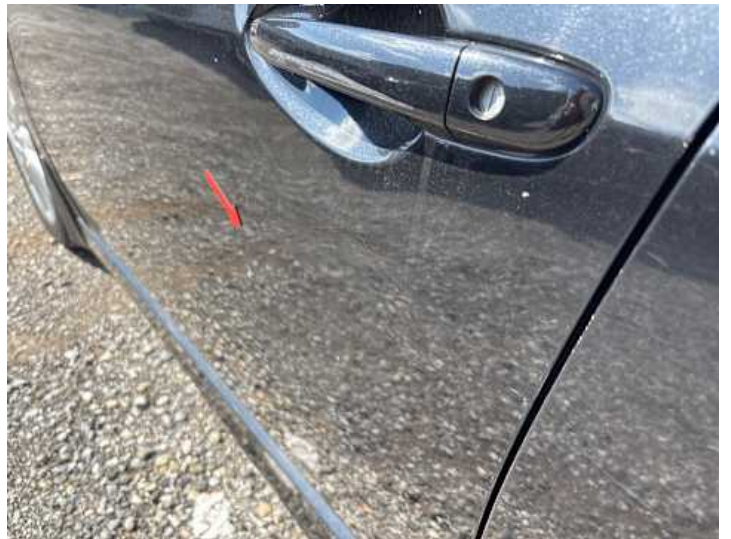
Fahrtür (Kratzer, Verformung)
