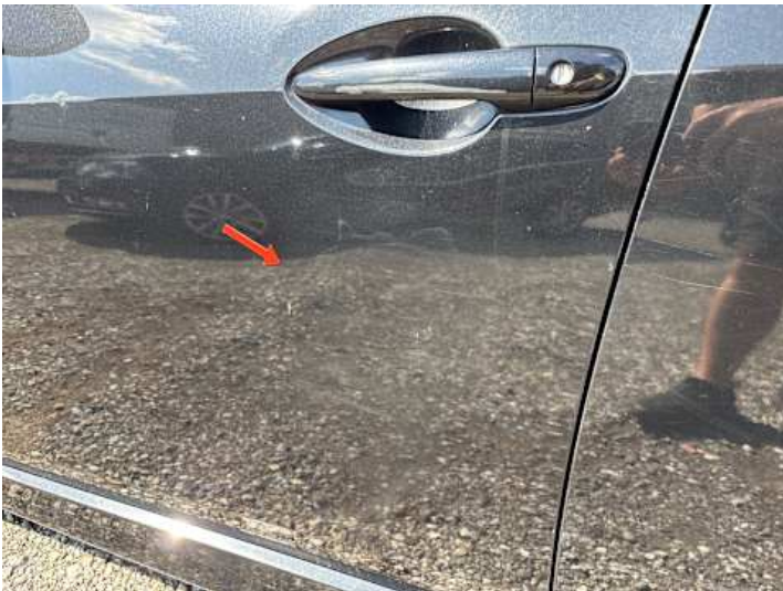
Fahrtür (Kratzer, Verformung)
