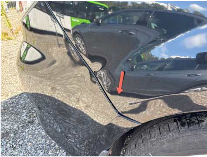
Stoßstange hinten (Spaltmaße ungenau)
