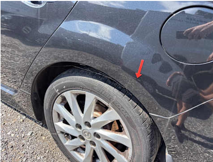
Seitenteil hinten links (Delle)
