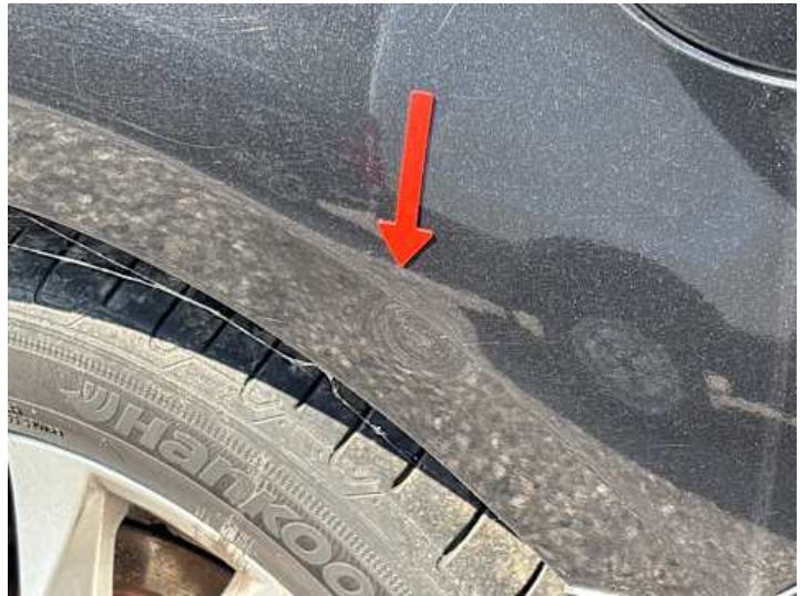
Seitenteil hinten links (Delle)
