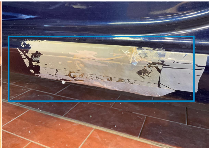
2. Einstiegsblech / MitteLinks Lack / Chemische Schäden -
