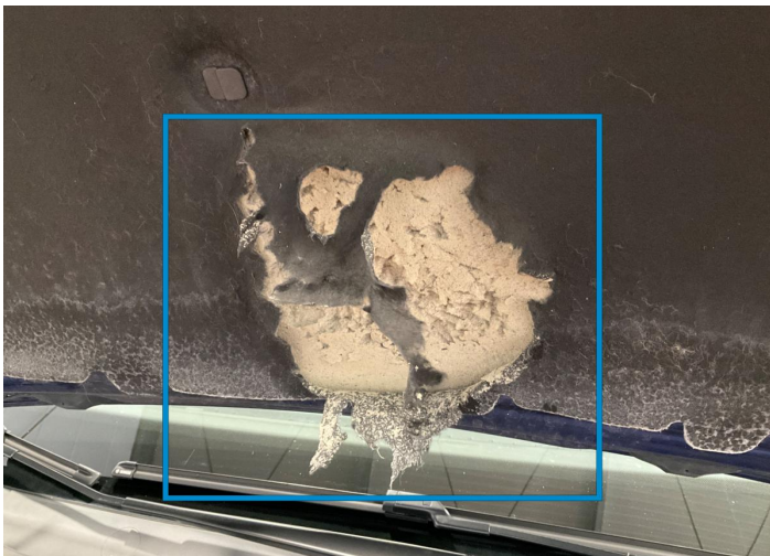
3. Haube / Vorn Lack / Chemische Schäden -
