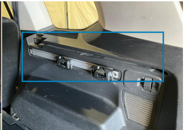
4. Gepäckraumabdeckung / hinten Innenraum / Fehlt -
