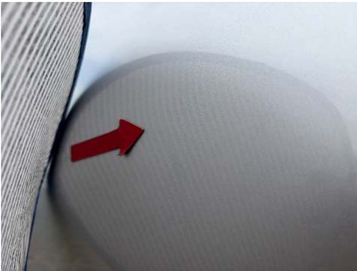
Türe hinten links (Delle, Kratzer)
