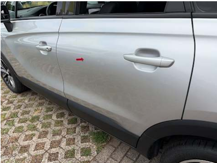
Türe hinten links (Delle, Kratzer)
