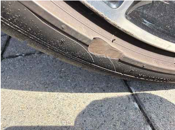
Rad (Kratzer, Riss/Bruch)
