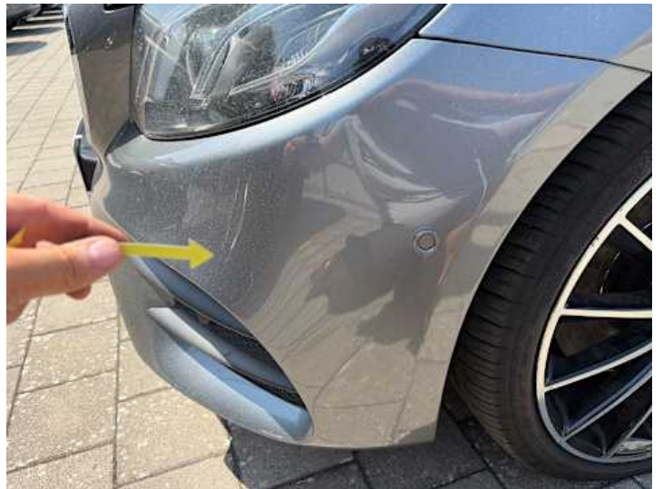
Stoßstange vorne (Unsachgemäß instand gesetzt)
