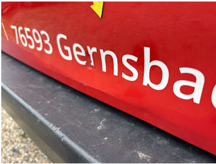
Heckklappe (Lackschaden, Verformung)
