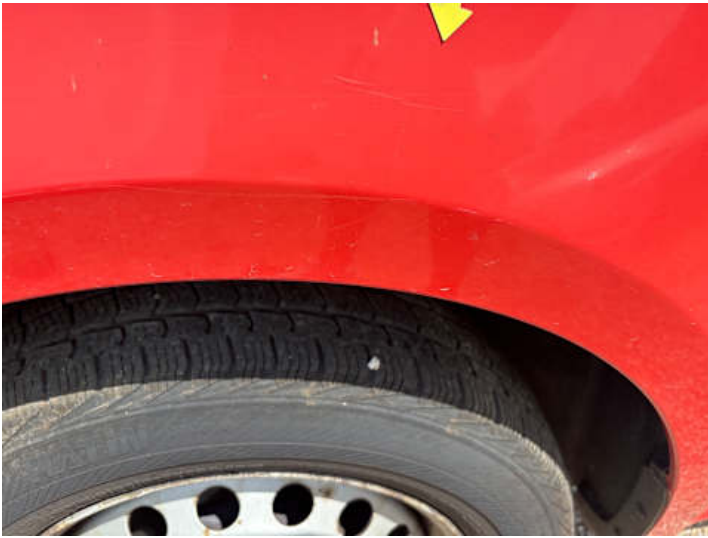
Kotflügel vorne links (Kratzer)
