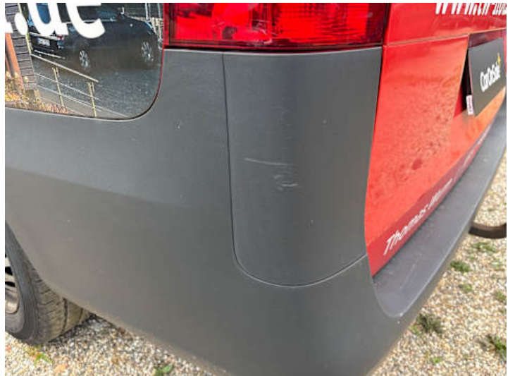
Stoßstange hinten (Kratzer, Verformung)
