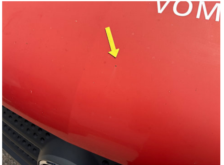
Motorhaube (Ausgeblichen/Matt, Lackschaden)
