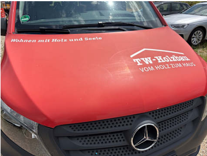
Motorhaube (Ausgeblichen/Matt, Lackschaden)
