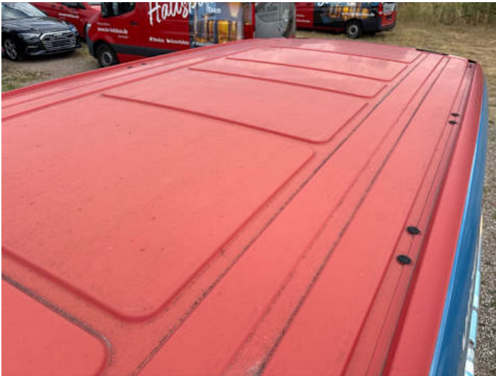
Dach (Ausgeblichen/Matt, Delle)
