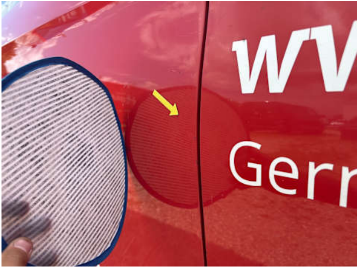
Seitenteil hinten rechts (Kratzer, Delle)
