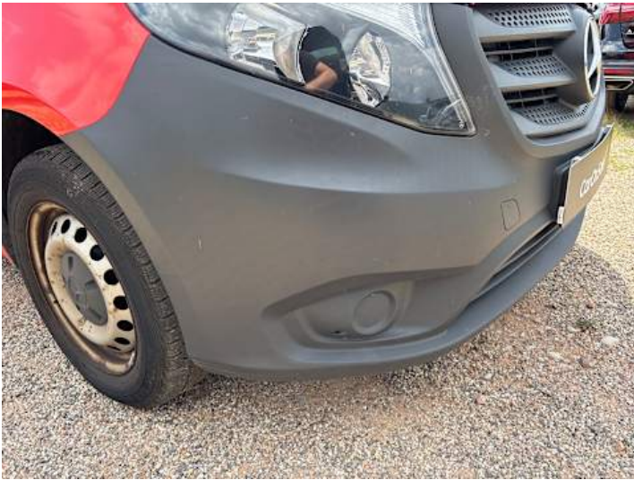
Stoßstange vorne (Ausgeblichen/Matt, Kratzer)
