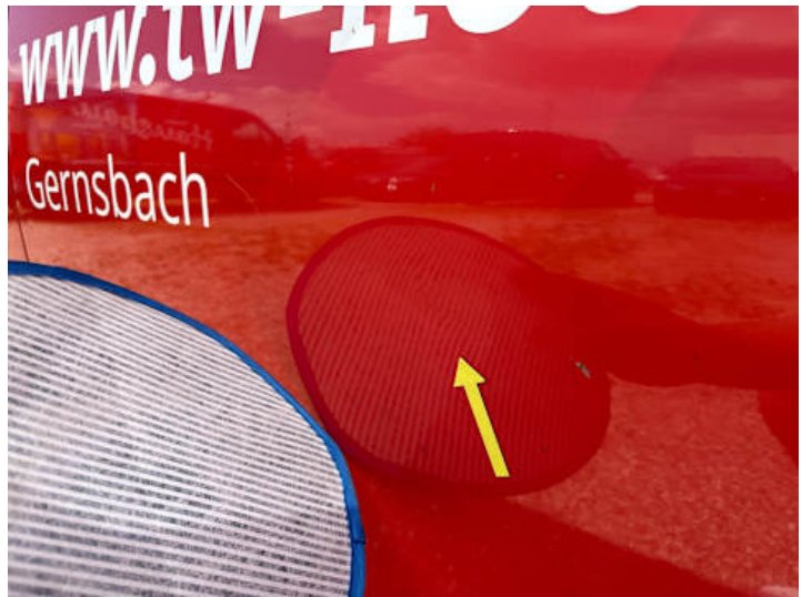
Beifahrertür (Delle, Kratzer)
