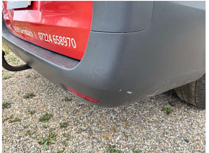
Stoßstange hinten (Kratzer, Verformung)
