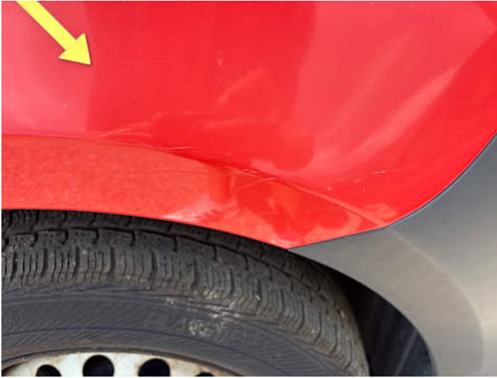
Kotflügel vorne rechts (Kratzer)
