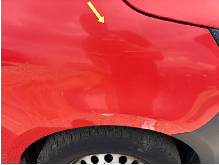
Kotflügel vorne rechts (Kratzer)
