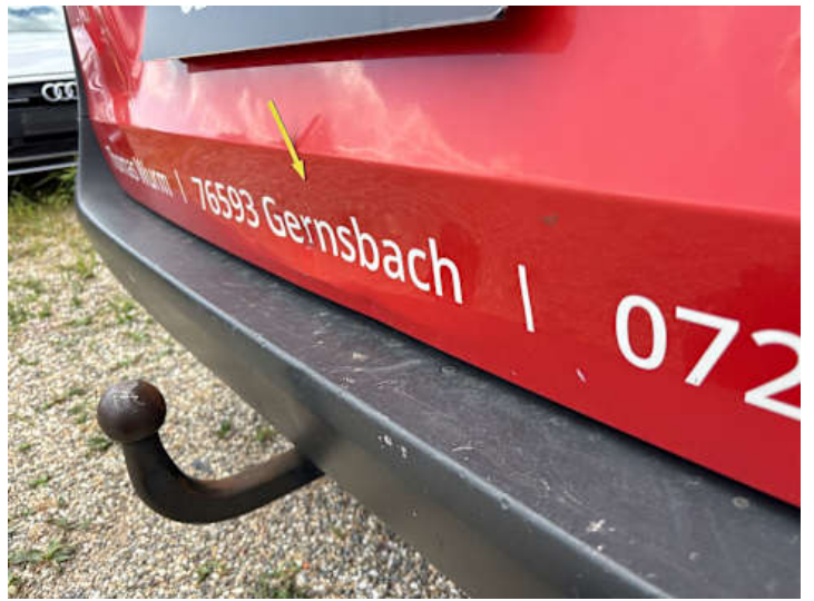
Heckklappe (Lackschaden, Verformung)
