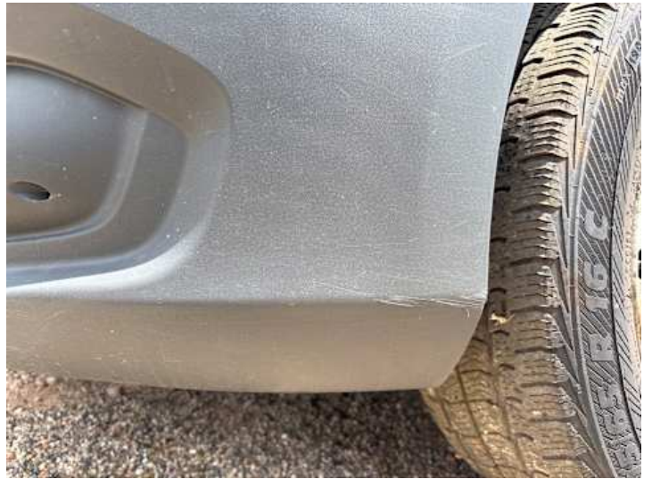
Stoßstange vorne (Ausgeblichen/Matt, Kratzer)
