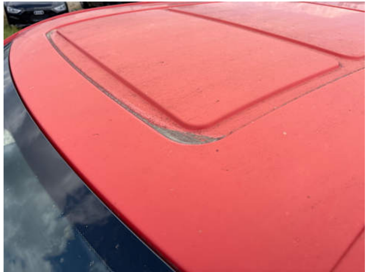
Dach (Ausgeblichen/Matt, Delle)
