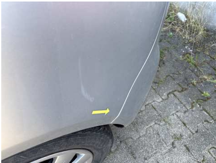
Stoßstange hinten (Spaltmaße ungenau)
