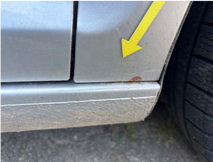
Schweller rechts (Rost)
