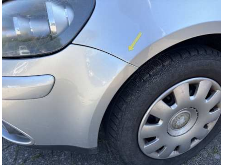
Stoßstange vorne (Spaltmaße ungenau)
