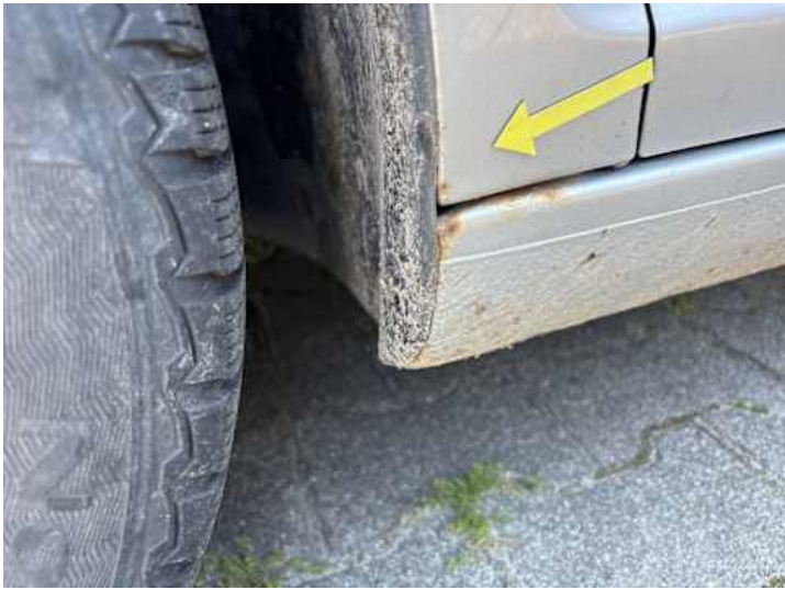
Kotflügel vorne links (Rost)
