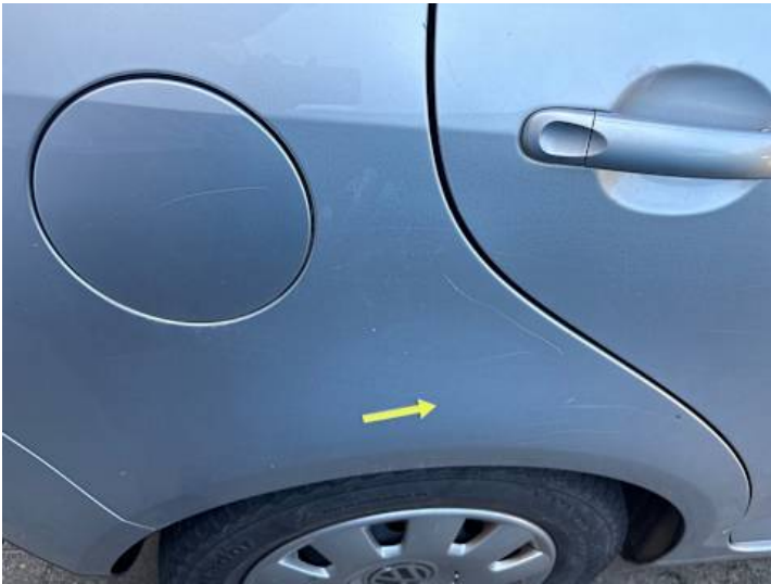
Seitenteil hinten rechts (Kratzer)
