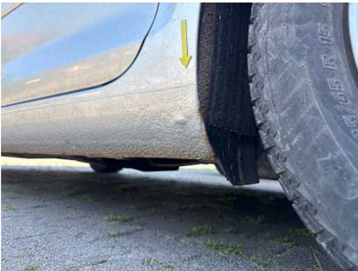
Schweller links (Rost)
