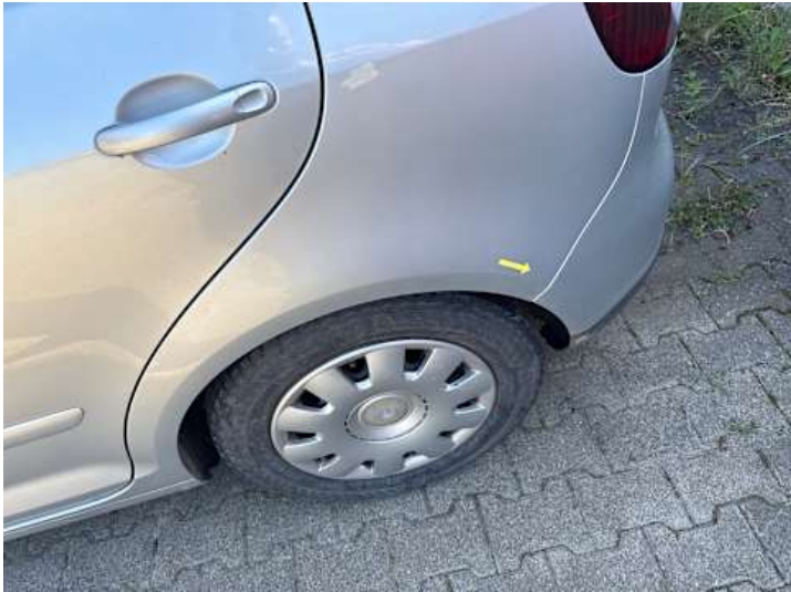
Stoßstange hinten (Spaltmaße ungenau)
