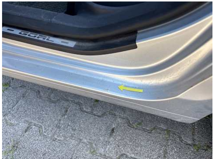
Schweller links (Rost)
