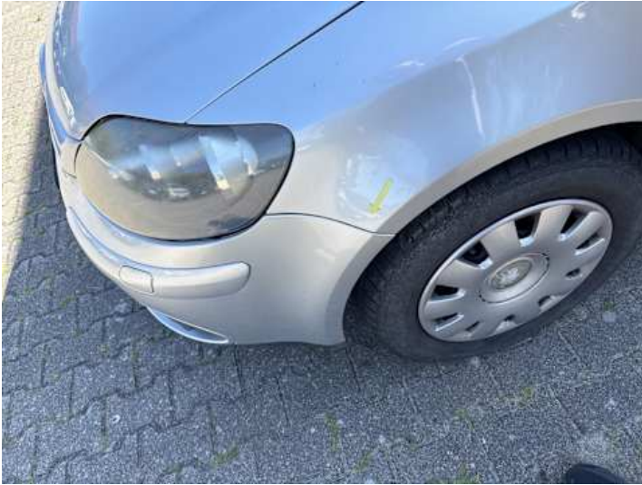
Stoßstange vorne (Spaltmaße ungenau)
