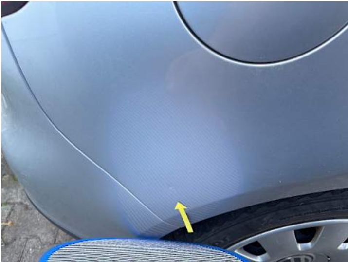
Seitenteil hinten rechts (Kratzer, Delle)
