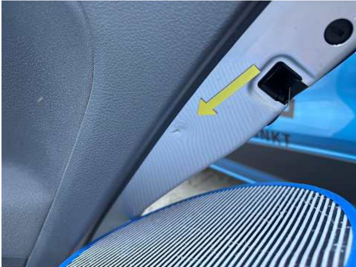
Türe hinten rechts (Kratzer, Delle)
