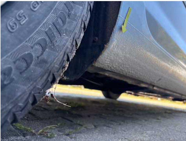
Schweller rechts (Rost)
