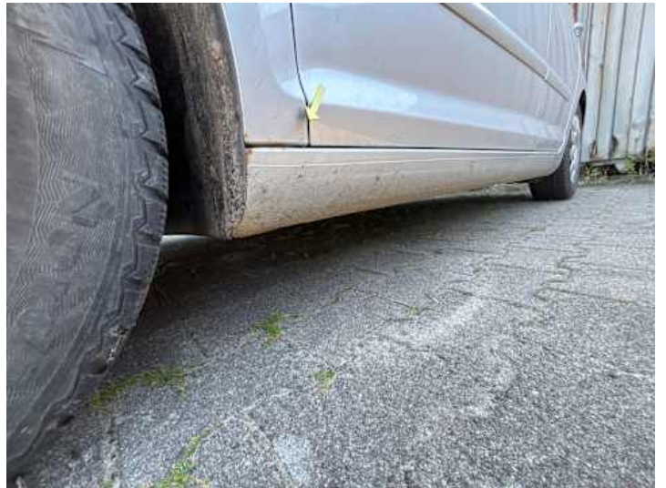
Schweller links (Rost)
