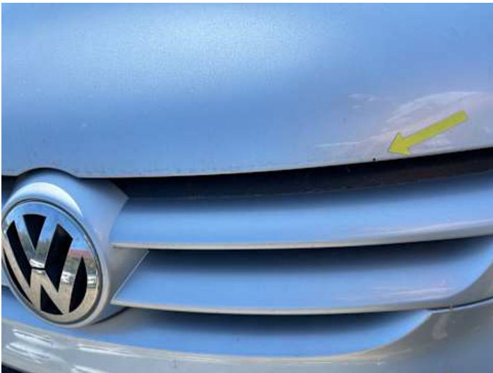
Motorhaube (Steinschlag, Rost)
