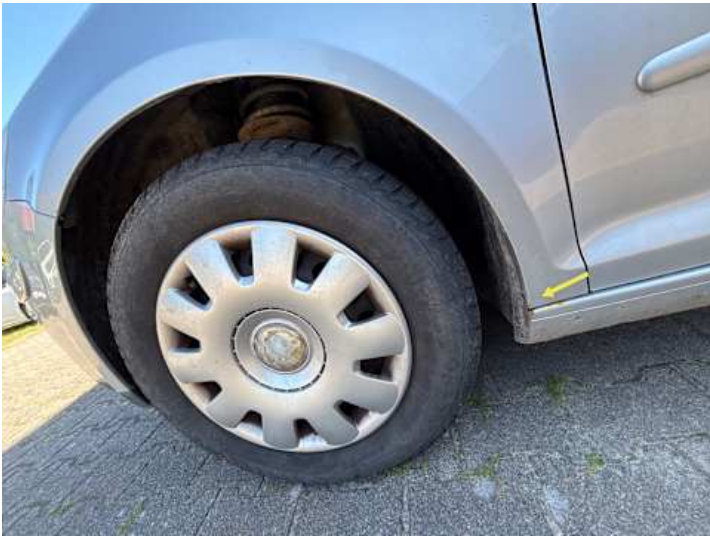
Kotflügel vorne links (Rost)
