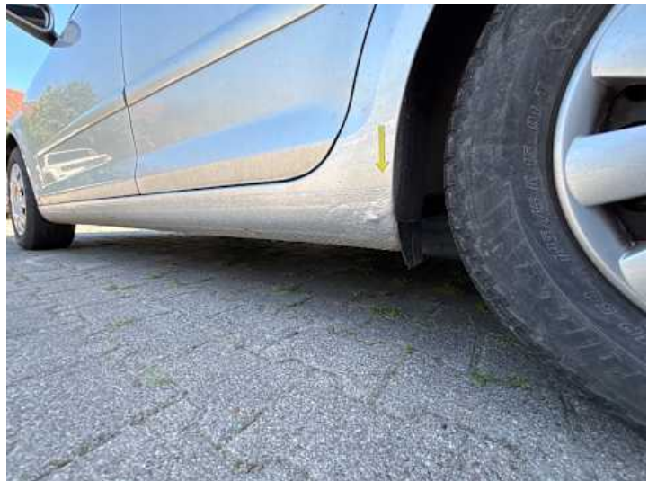
Schweller links (Rost)
