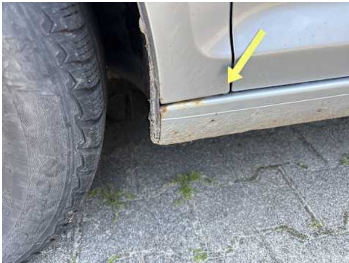
Schweller links (Rost)
