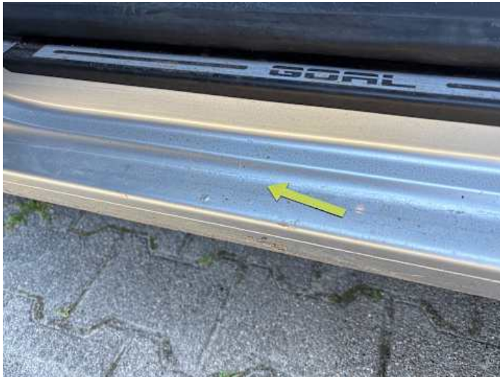
Schweller links (Rost)
