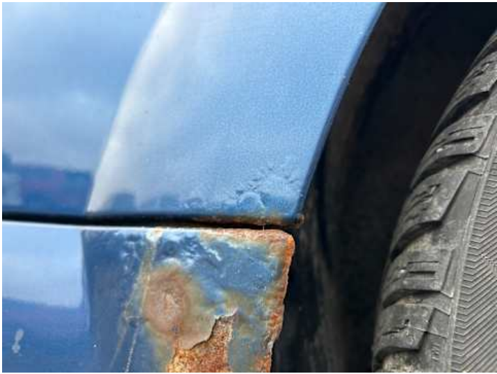
Seitenteil hinten links (Rost)
