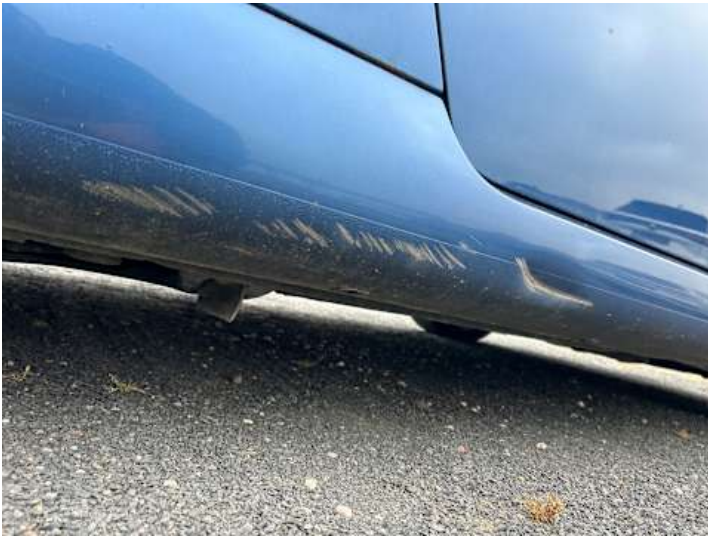
Schweller rechts (Verformung, Lackschaden)
