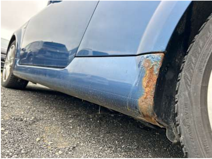
Schweller links (Rost)
