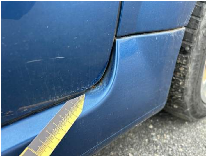
Schweller rechts (Rost)
