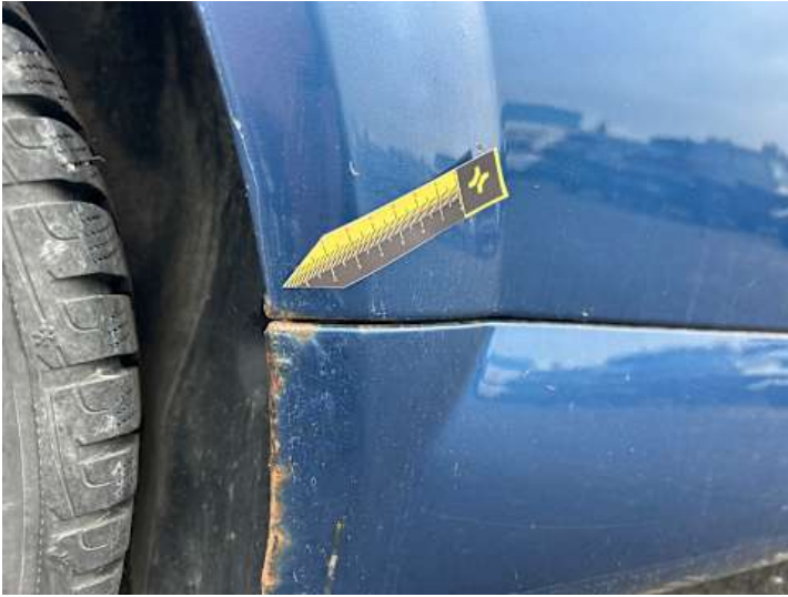
Seitenteil hinten rechts (Rost)
