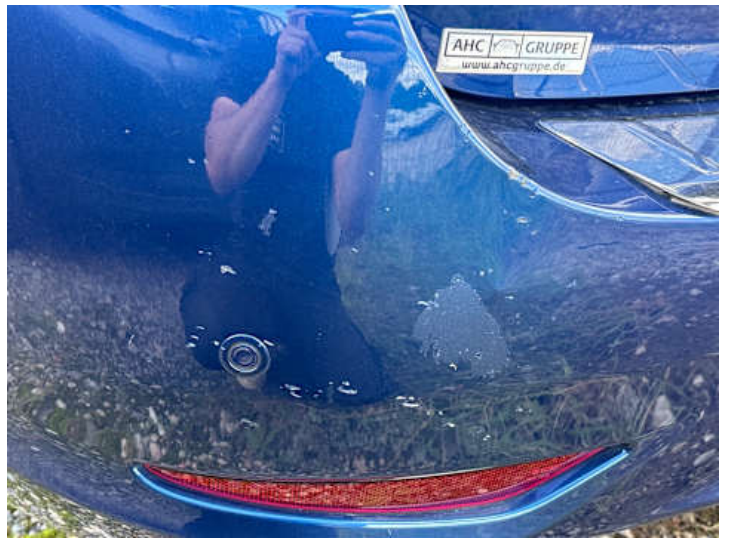
Stoßstange hinten (Lackschaden, Delle, Verformung)
