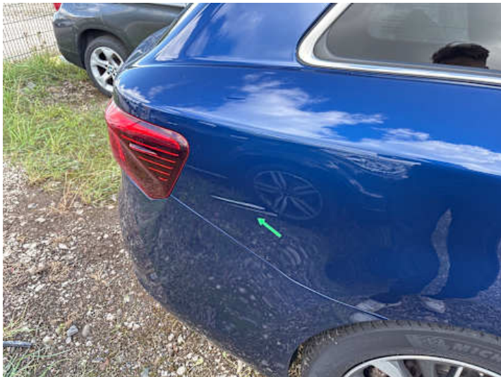
Seitenteil hinten rechts (Kratzer, Lackschaden)
