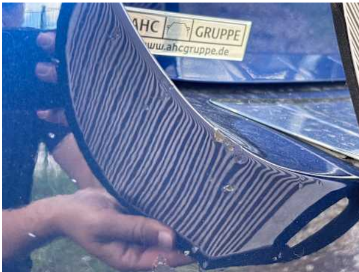
Stoßstange hinten (Lackschaden, Delle, Verformung)
