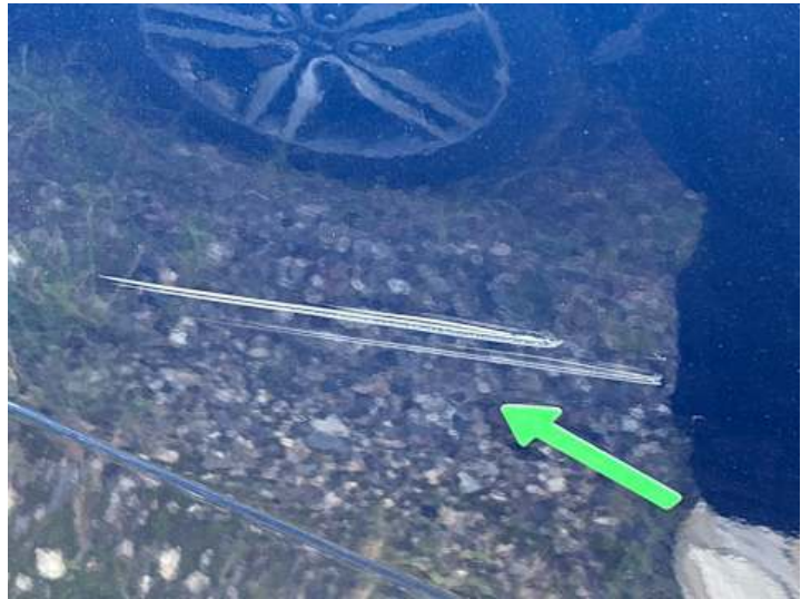
Seitenteil hinten rechts (Kratzer, Lackschaden)
