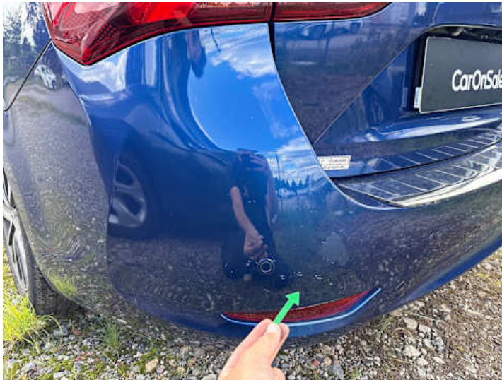
Stoßstange hinten (Lackschaden, Delle, Verformung)
