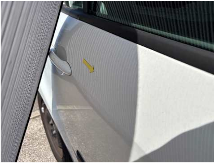
Türe hinten rechts (Delle)
