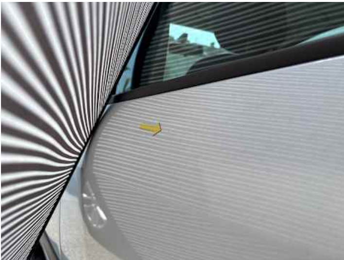
Türe hinten links (Delle)
