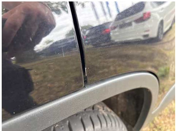
Türe hinten rechts (Delle, Lackschaden, Kratzer)
