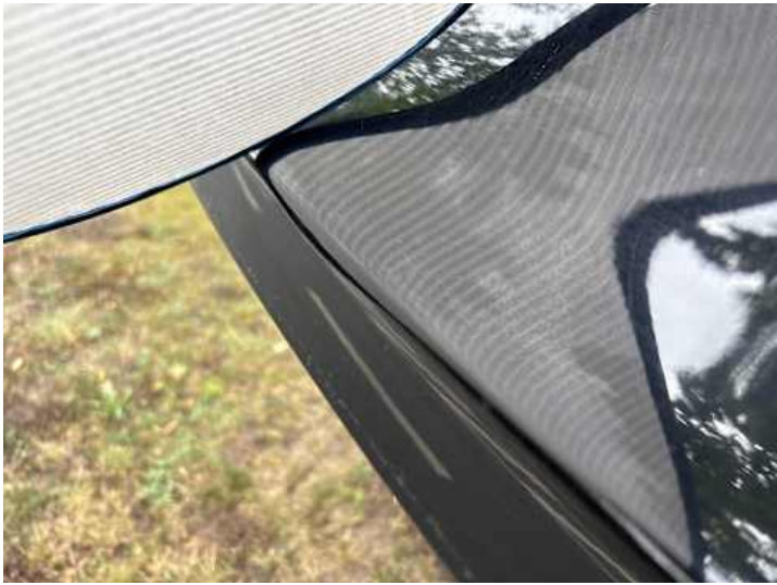
Heckklappe (Delle, Kratzer)
