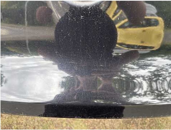
Heckklappe (Delle, Kratzer)
