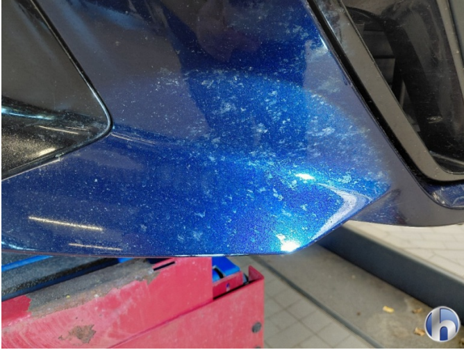
1. Stoßfänger Vorne Verformt
