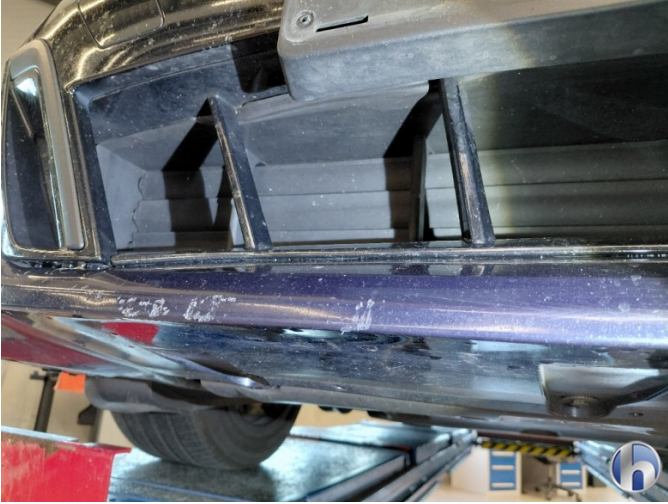
1. Stoßfänger Vorne Verformt
