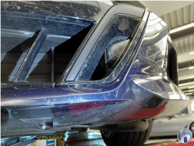
1. Stoßfänger Vorne Verformt
