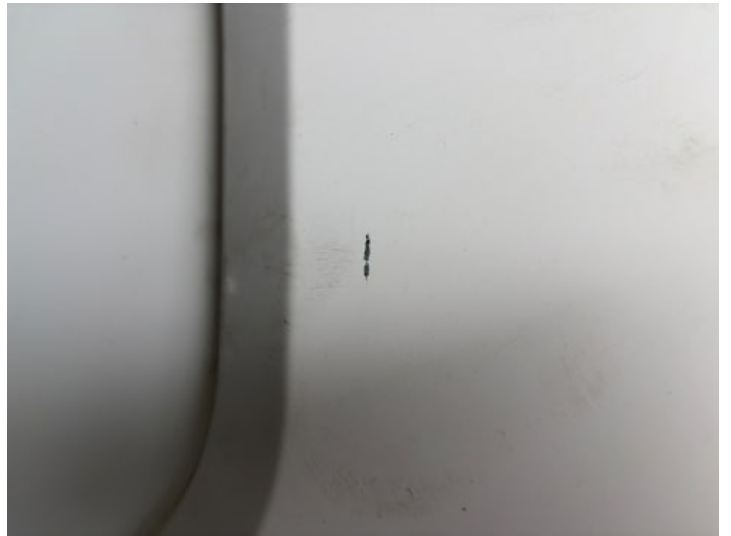
Seitenteil hinten links (Lackschaden)
