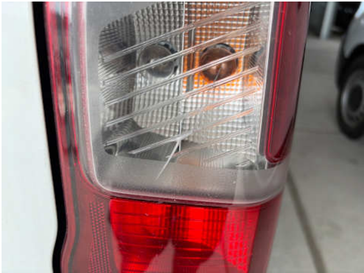
Rücklicht (rechts) (Riss/Bruch)
