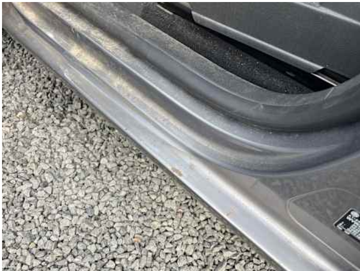
Schweller links (Rost)
