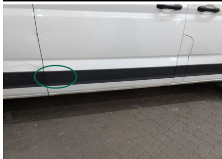
Türzierleiste / Rechts / Kratzer
