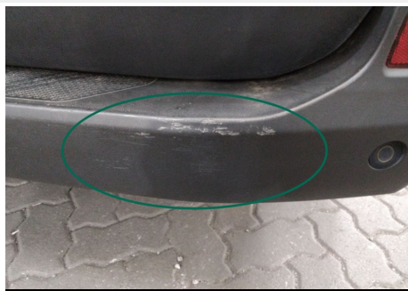
Stoßfänger / Hinten / Kratzer
