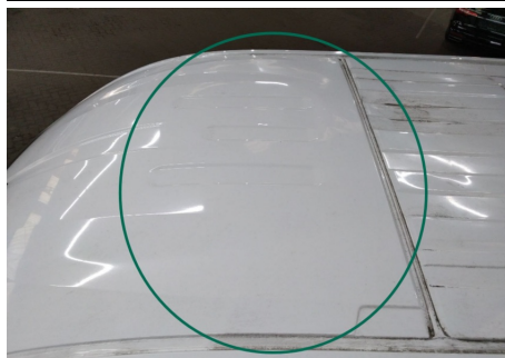
Dach / Vorne / Delle
