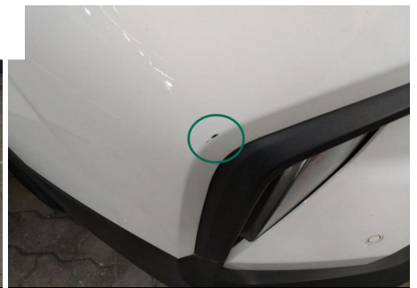
Stoßfänger oberhalb / Vorne / Kratzer
