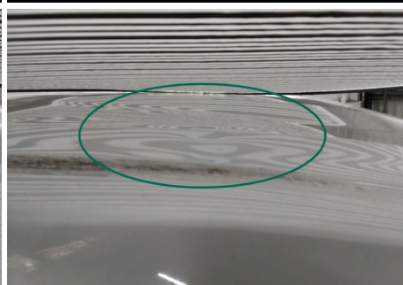
Dach / Vorne / Delle
