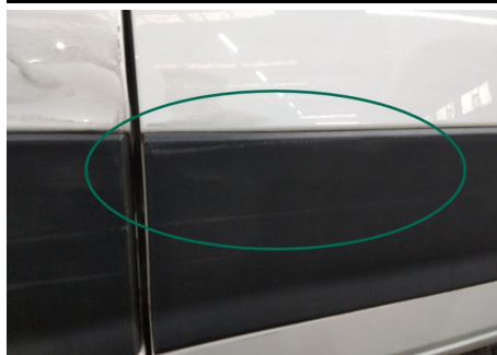
Türzierleiste / Rechts / Kratzer
