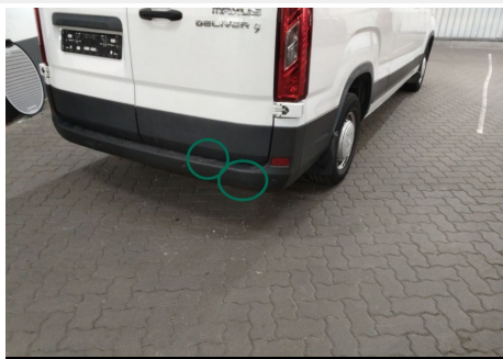
Stoßfänger / Hinten / Kratzer
