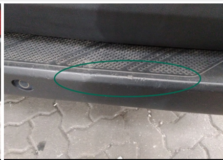
Stoßfänger / Hinten / Kratzer
