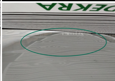
Dach / Vorne / Delle
