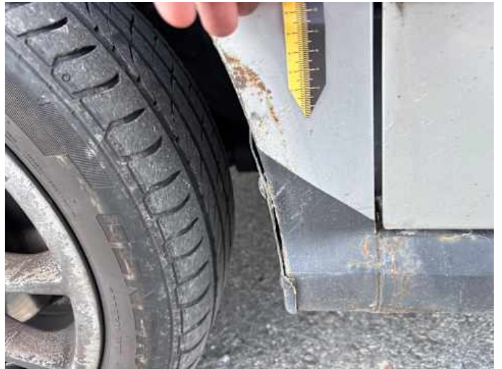
Kotflügel vorne links (Rost, Unsachgemäß instand gesetzt)
