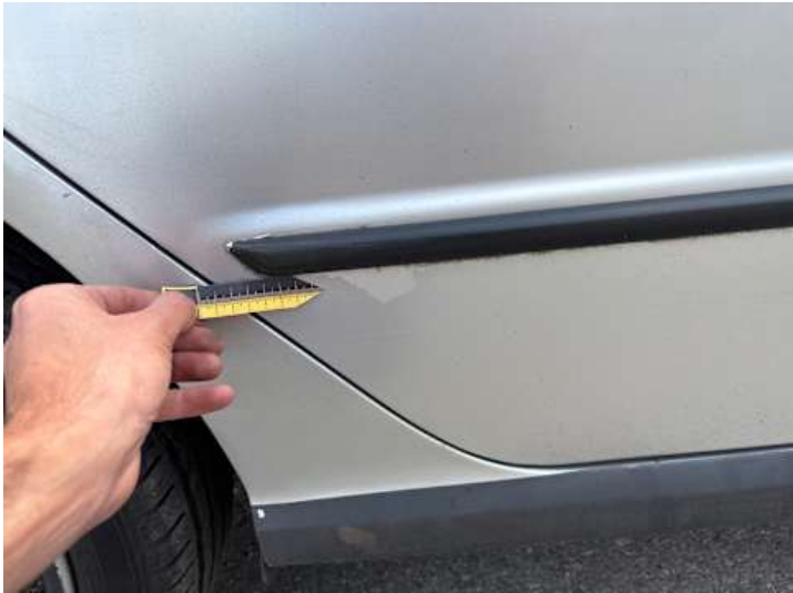
Türe hinten rechts (Lackschaden)
