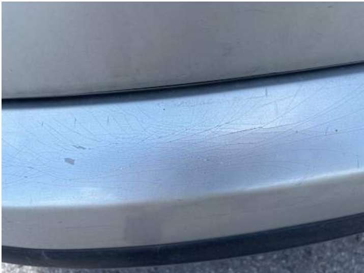
Stoßstange hinten (Riss/Bruch)
