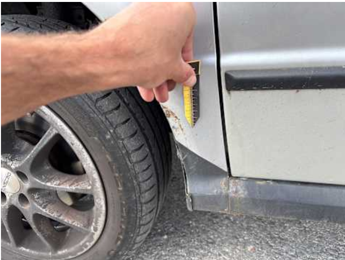
Kotflügel vorne links (Rost, Unsachgemäß instand gesetzt)
