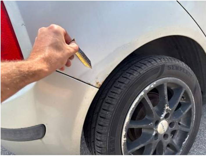
Seitenteil hinten rechts (Rost)
