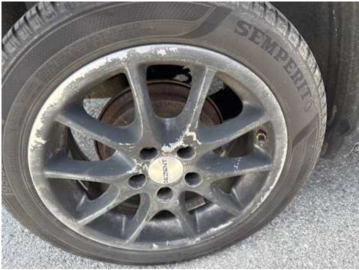
Rad (Anderer Schaden): Lackschaden
