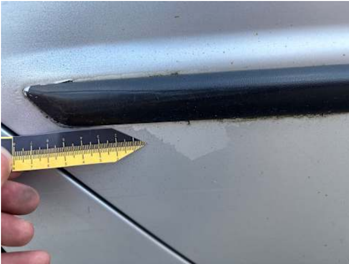
Türe hinten rechts (Lackschaden)
