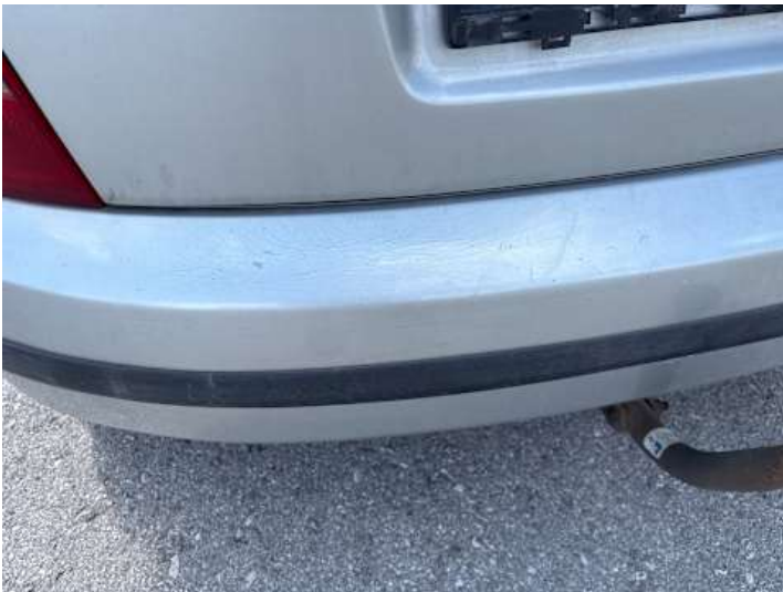
Stoßstange hinten (Riss/Bruch)
