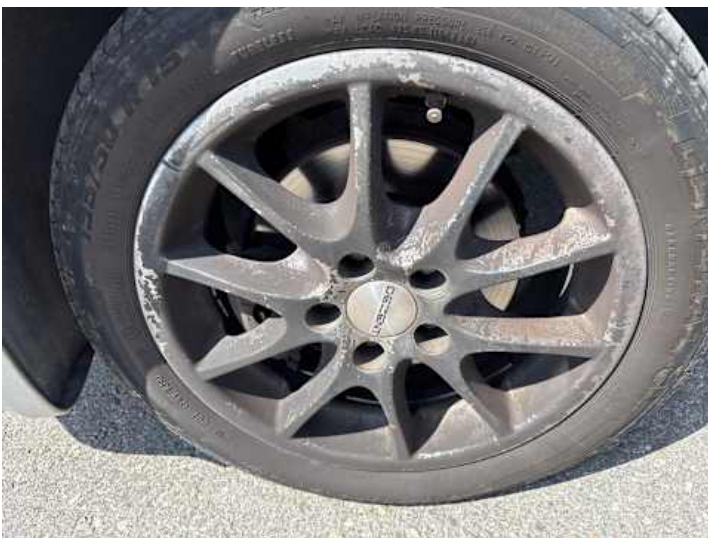
Rad (Anderer Schaden): Lackschaden
