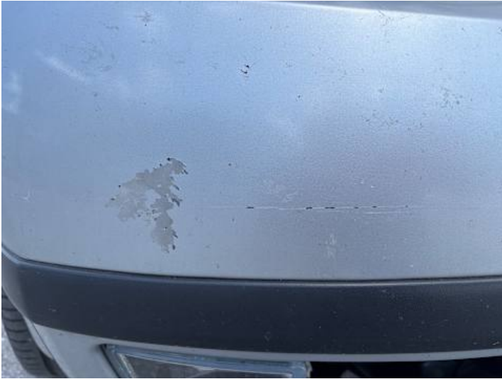
Stoßstange vorne (Lackschaden, Anderer Schaden): Abdeckung fehlt
