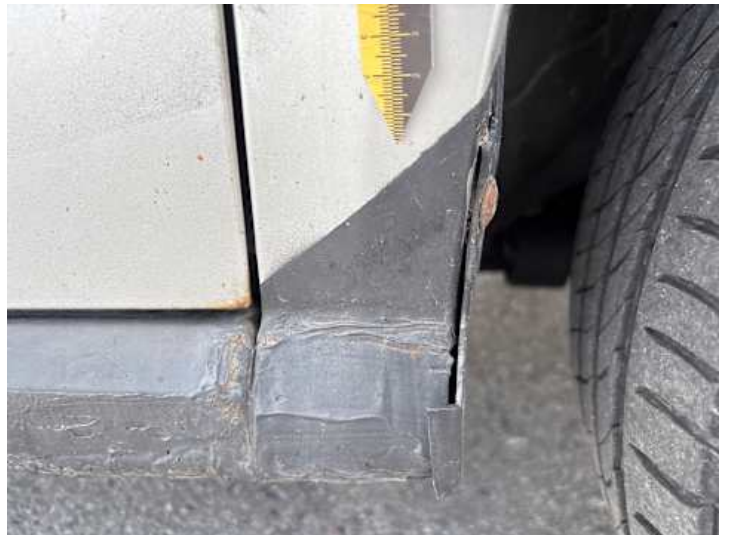
Kotflügel vorne rechts (Rost, Unsachgemäß instand gesetzt)
