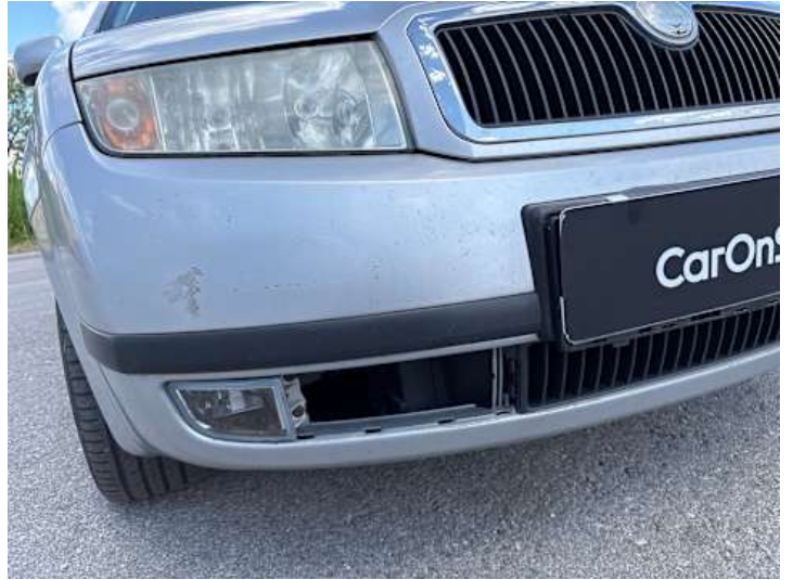
Stoßstange vorne (Lackschaden, Anderer Schaden): Abdeckung fehlt
