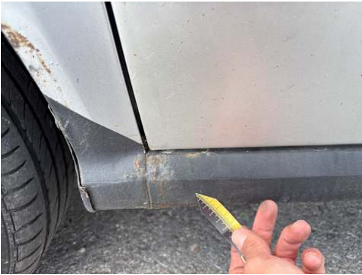
Schweller links (Rost, Unsachgemäß instand gesetzt)
