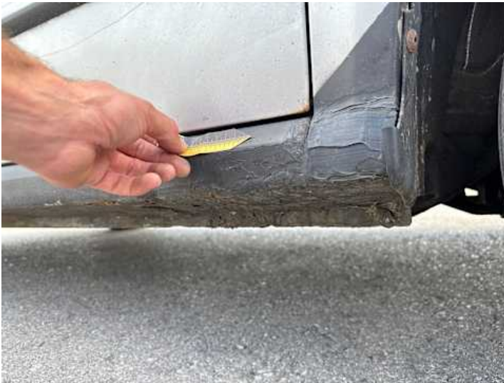
Schweller rechts (Rost, Unsachgemäß instand gesetzt)
