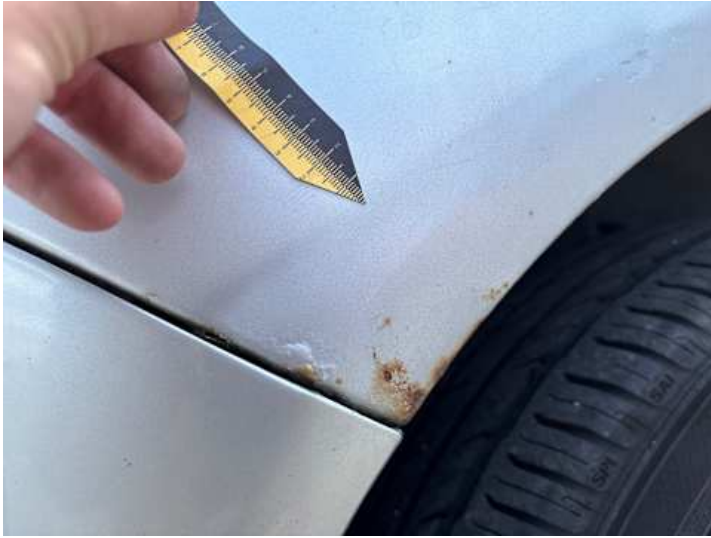
Seitenteil hinten rechts (Rost)
