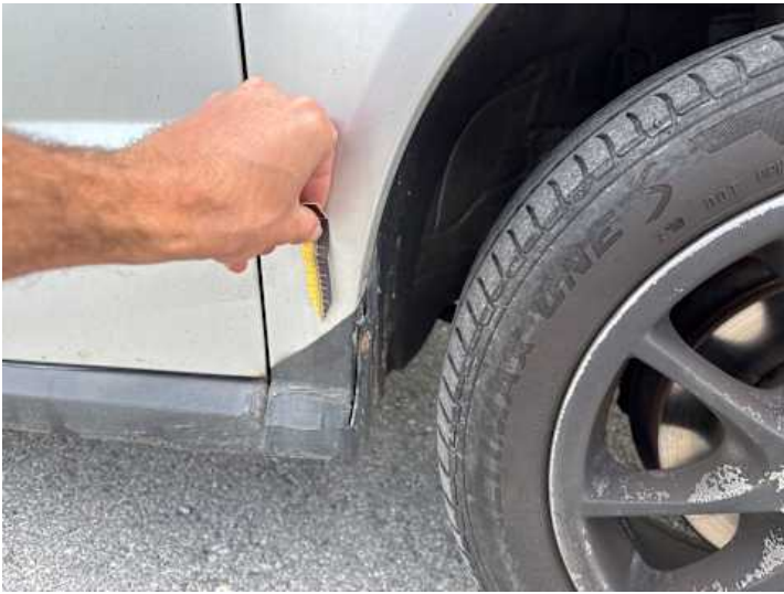
Kotflügel vorne rechts (Rost, Unsachgemäß instand gesetzt)
