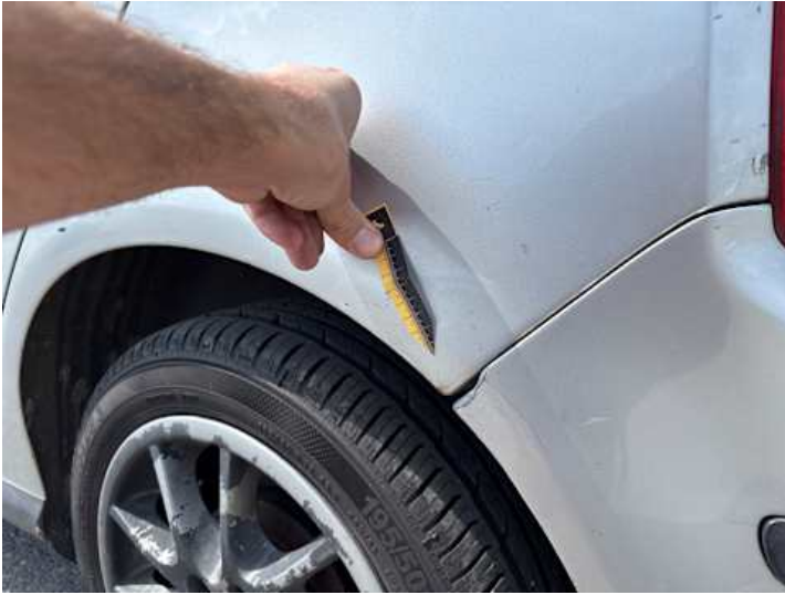
Seitenteil hinten links (Rost)
