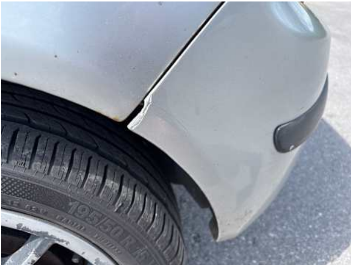
Stoßstange hinten (Riss/Bruch)
