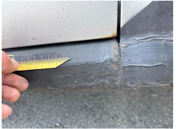
Schweller rechts (Rost, Unsachgemäß instand gesetzt)
