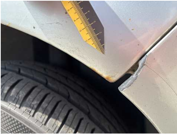
Seitenteil hinten links (Rost)
