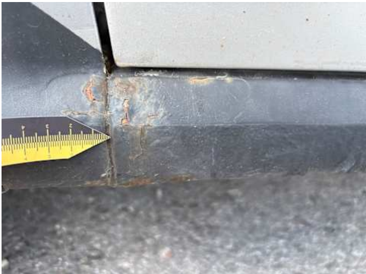
Schweller links (Rost, Unsachgemäß instand gesetzt)
