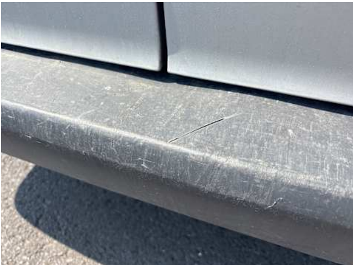
Stoßstange hinten (Kratzer)
