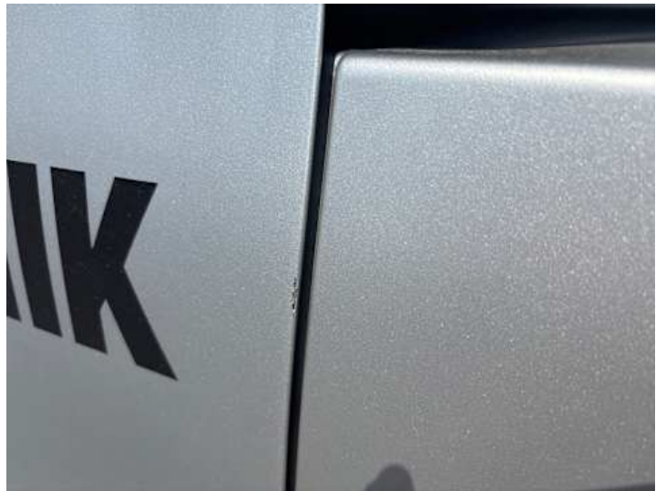
Türe hinten links (Kratzer)
