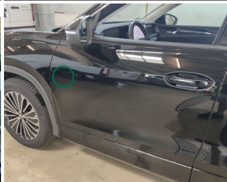
Tür / Vorne Links / Delle
