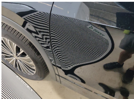
Tür / Vorne Links / Delle
