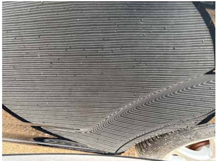
Türe hinten links (Unsachgemäß instand gesetzt)
