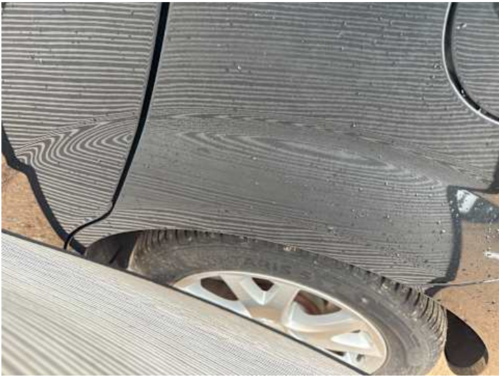
Seitenteil hinten links (Unsachgemäß instand gesetzt)
