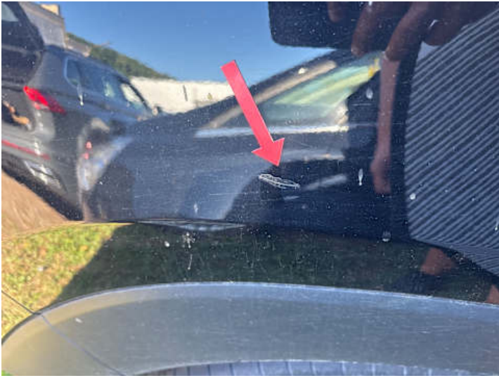
Seitenteil hinten rechts (Lackschaden)
