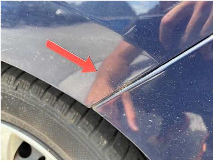
Seitenteil hinten links (Rost)
