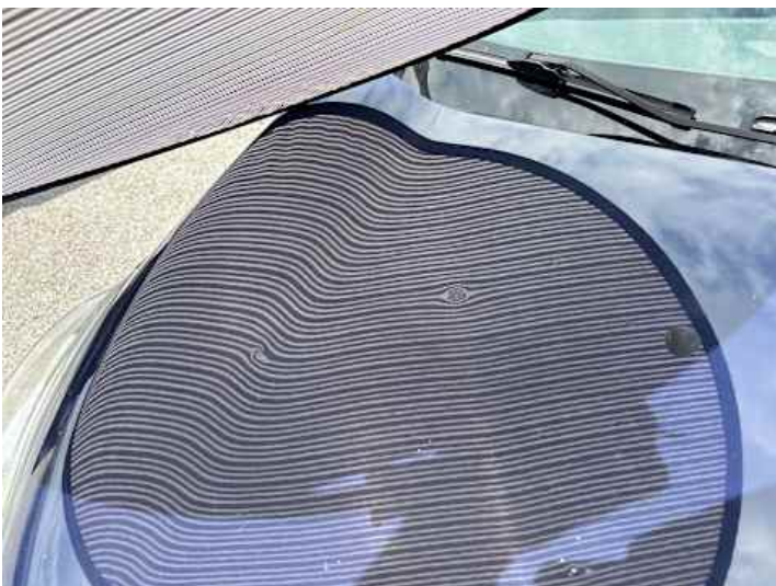
Motorhaube (Delle, Lackschaden)
