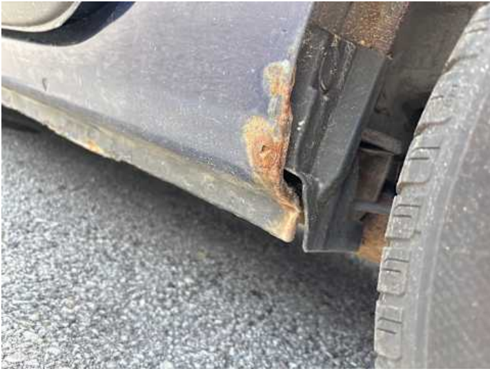
Schweller links (Rost)
