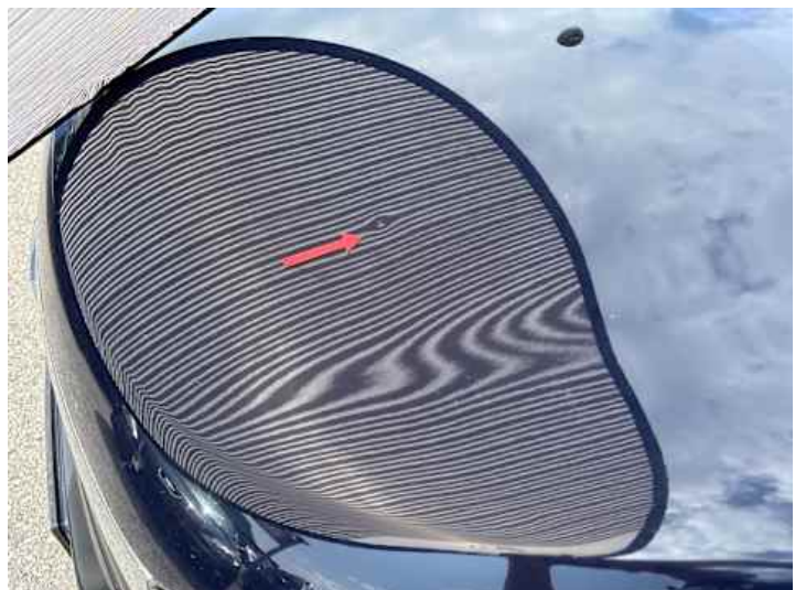
Motorhaube (Delle, Lackschaden)
