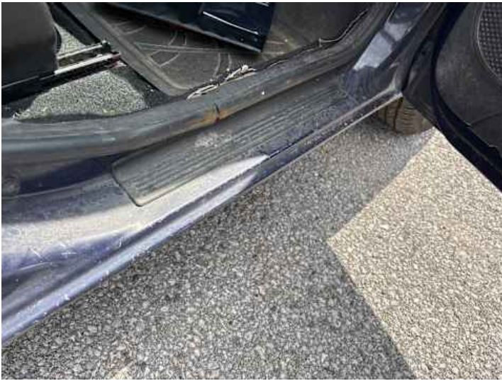
Schweller rechts (Kratzer, Delle)
