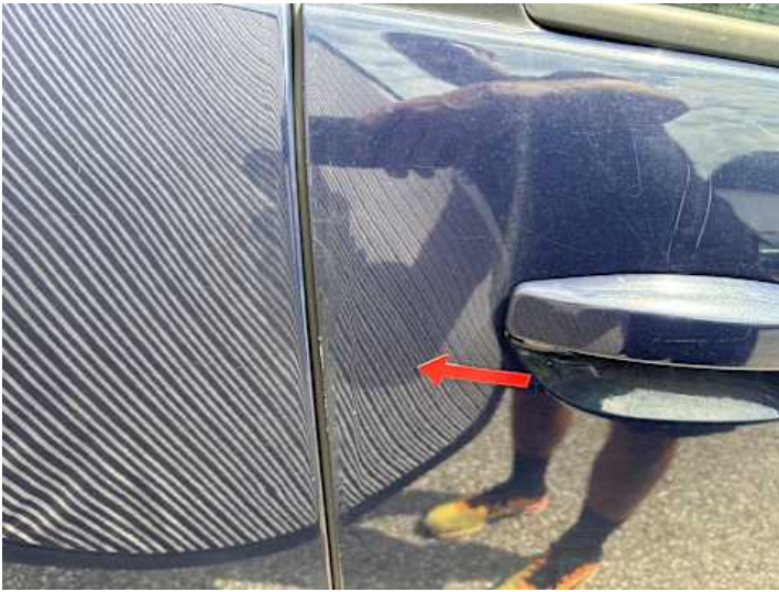
Beifahrertür (Verformung, Lackschaden, Kratzer)
