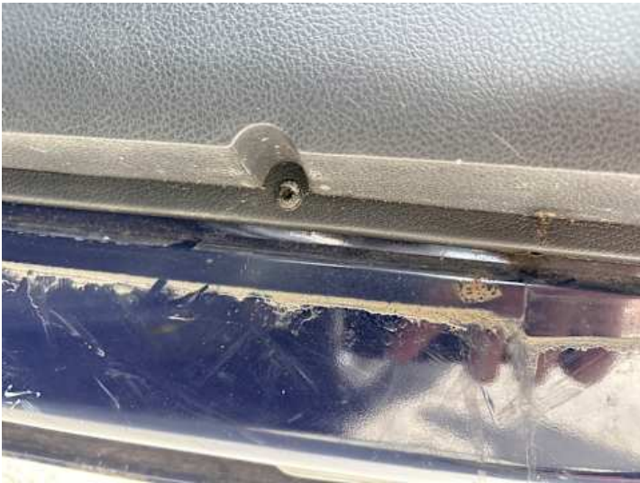
Türe hinten rechts (Rost)
