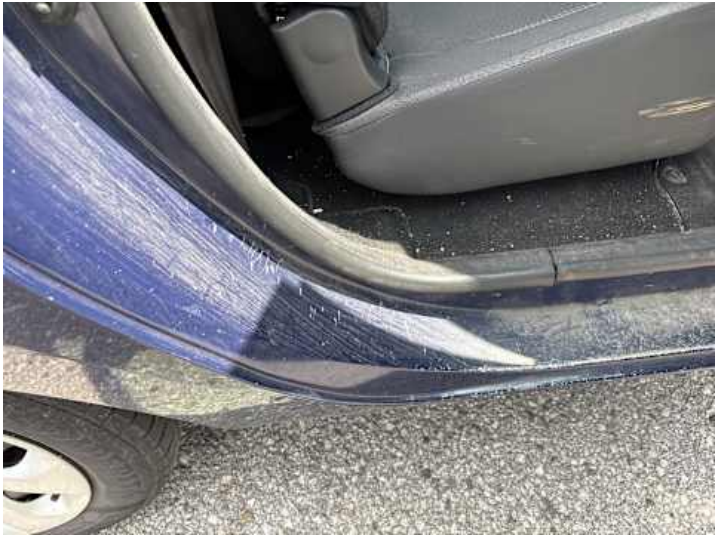
Schweller rechts (Kratzer, Delle)
