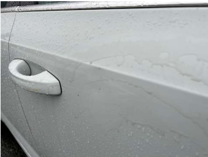
Beifahrertür (Delle, Kratzer)
