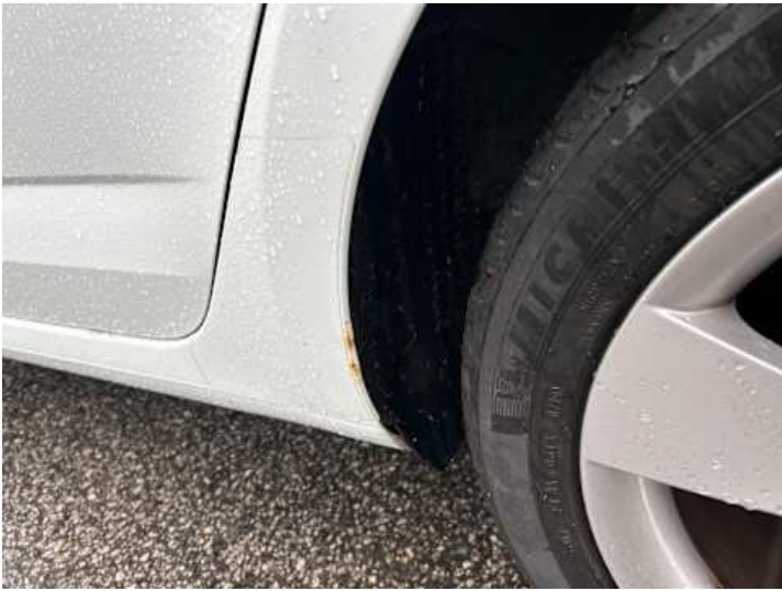
Seitenteil hinten links (Rost)
