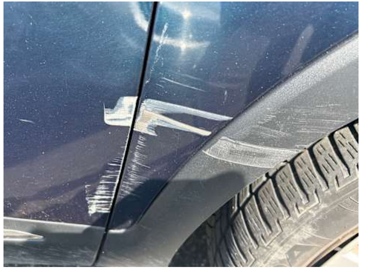
Kotflügel vorne rechts (Kratzer, Lackschaden)
