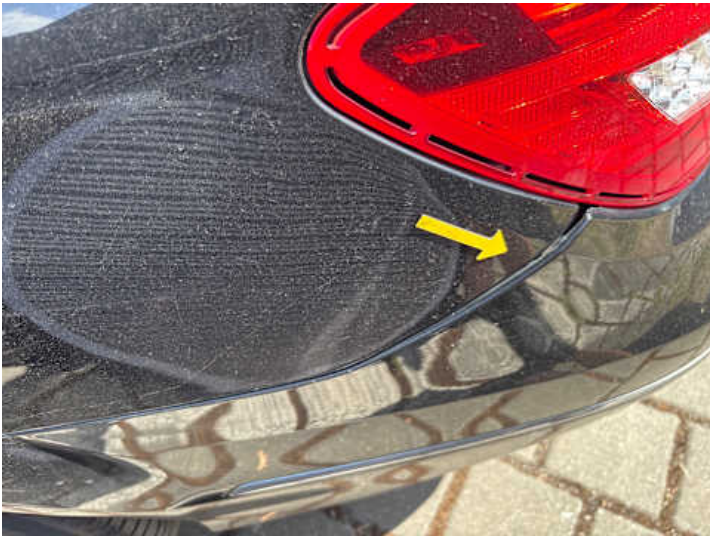
Stoßstange hinten (Spaltmaße ungenau)
