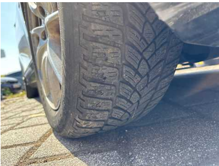
Rad (Ungleichmäßig abgefahren, Riss/Bruch)
