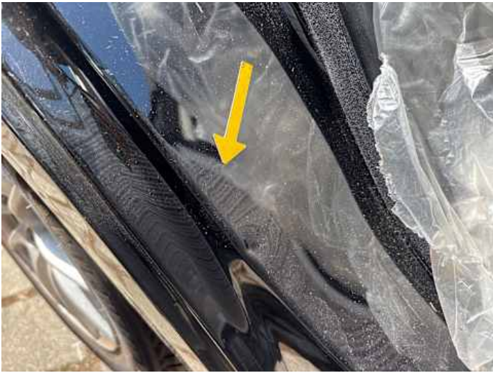
Türe hinten rechts (Delle)
