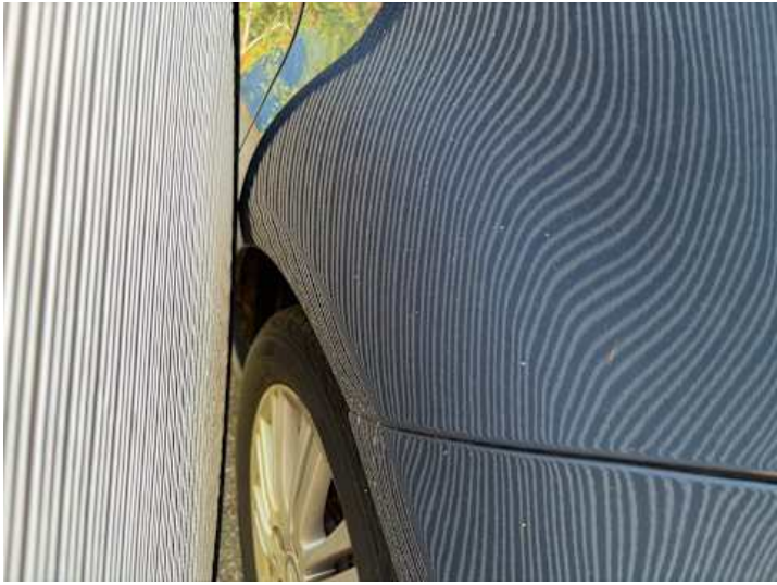
Seitenteil hinten links (Delle, Verformung)
