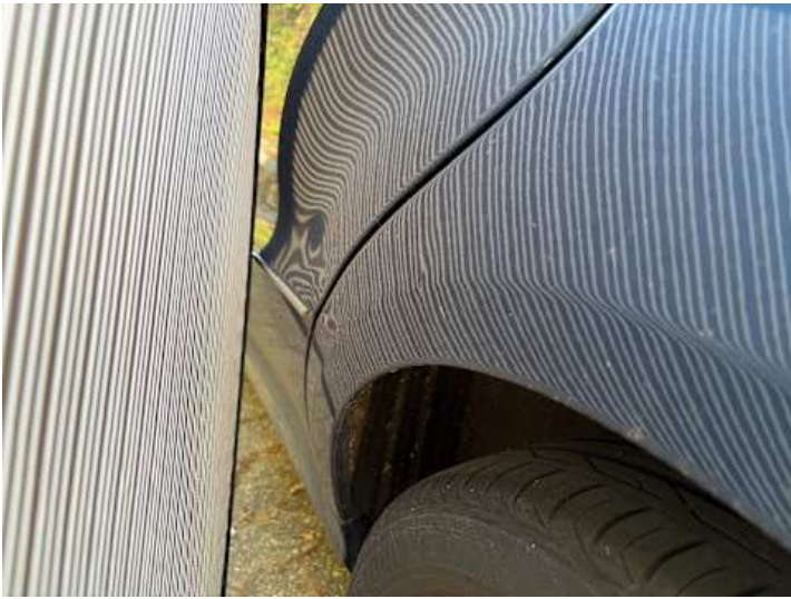
Seitenteil hinten links (Delle, Verformung)
