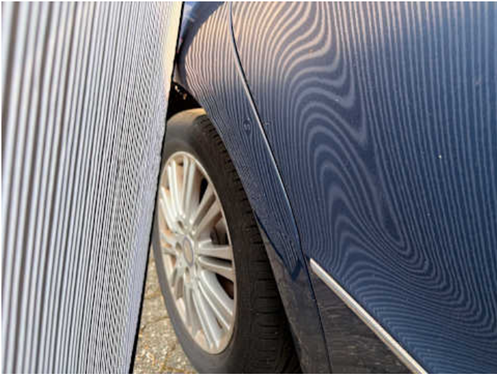
Seitenteil hinten rechts (Delle, Verformung)
