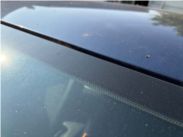
Dach (Lackschaden, Steinschlag)
