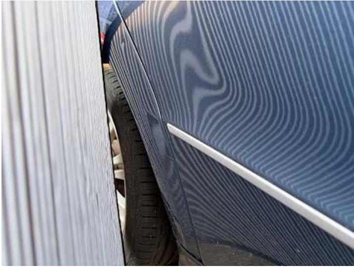
Seitenteil hinten rechts (Delle, Verformung)
