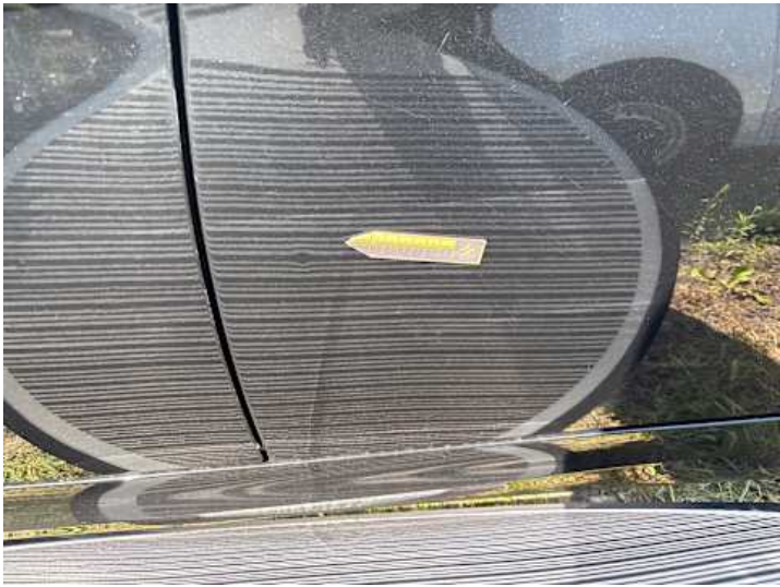
Türe hinten links (Delle)
