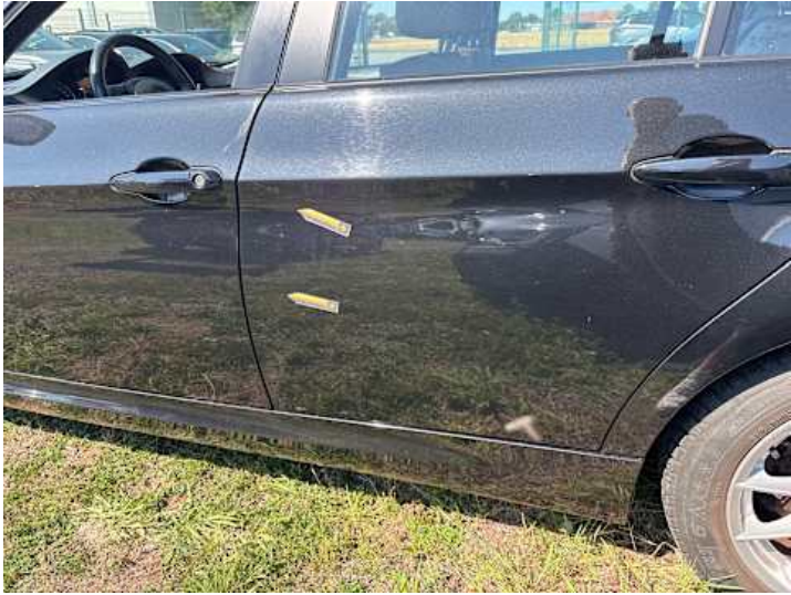
Türe hinten links (Delle, Kratzer)
