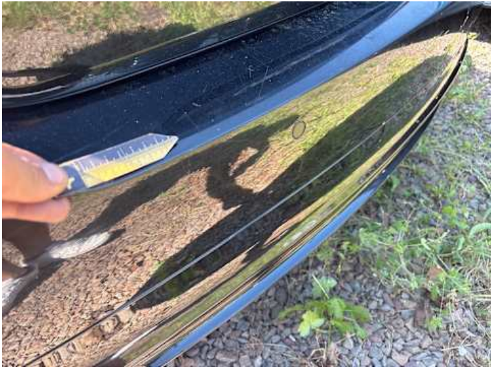
Stoßstange hinten (Kratzer, Lackschaden)
