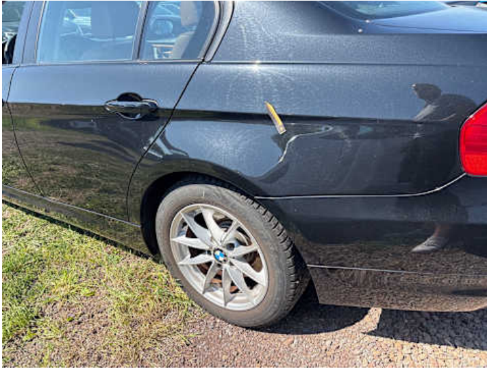
Seitenteil hinten links (Kratzer)
