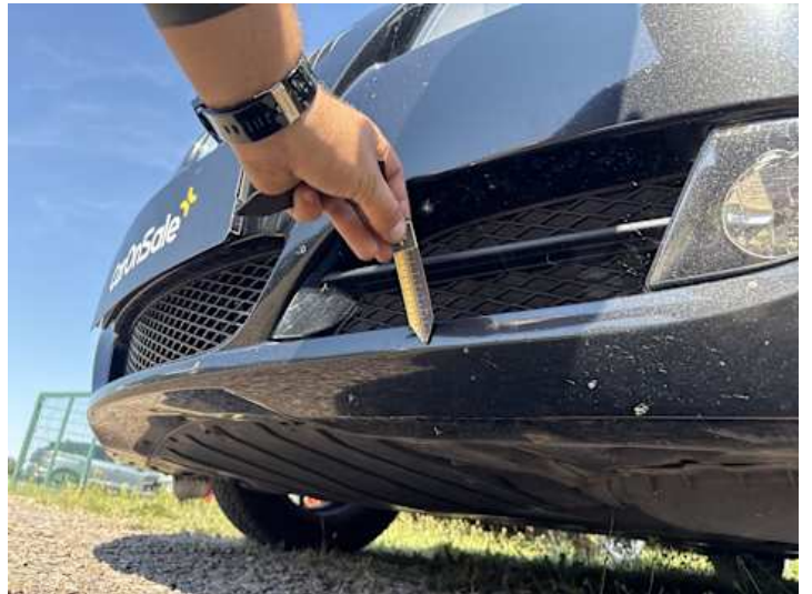
Stoßstange vorne (Lackschaden)
