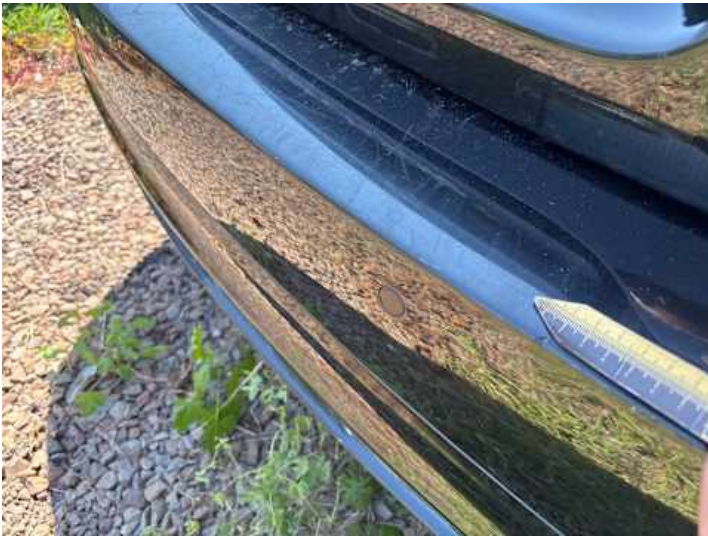
Stoßstange hinten (Kratzer, Lackschaden)
