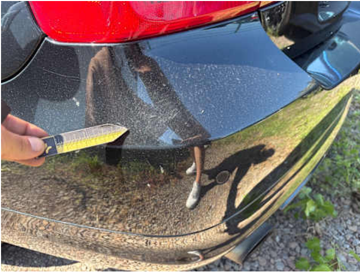
Stoßstange hinten (Kratzer, Lackschaden)
