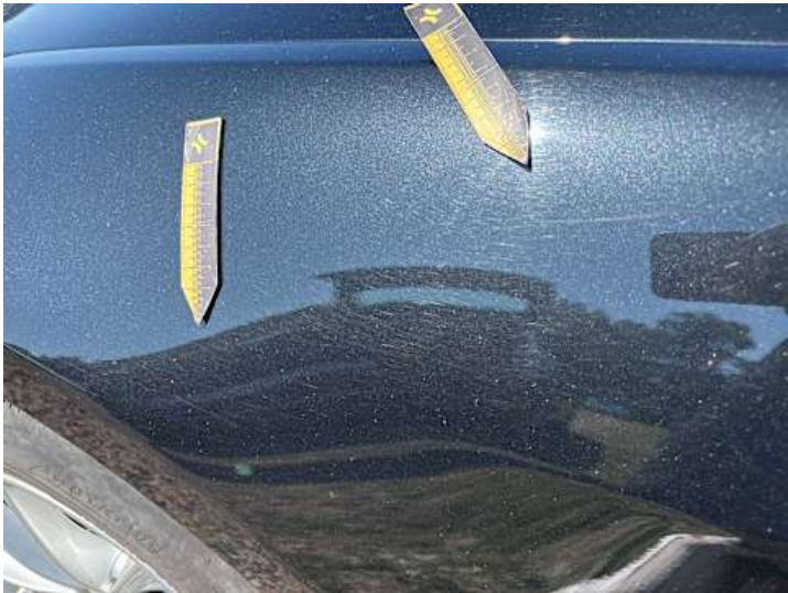
Kotflügel vorne links (Kratzer)
