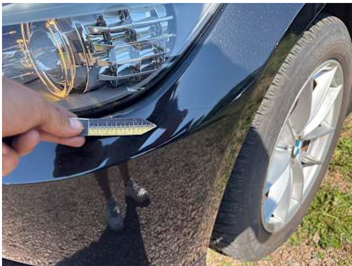
Stoßstange vorne (Lackschaden)
