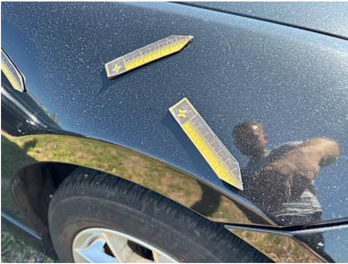
Kotflügel vorne rechts (Kratzer)
