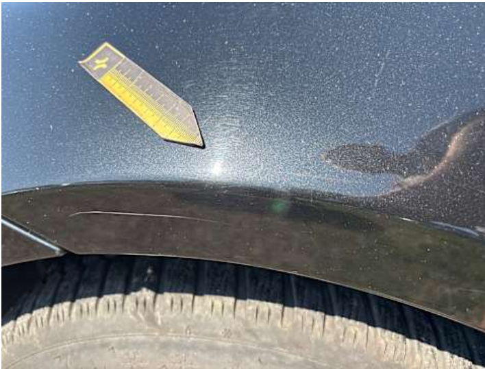
Kotflügel vorne links (Kratzer)
