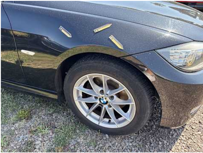
Kotflügel vorne rechts (Kratzer)
