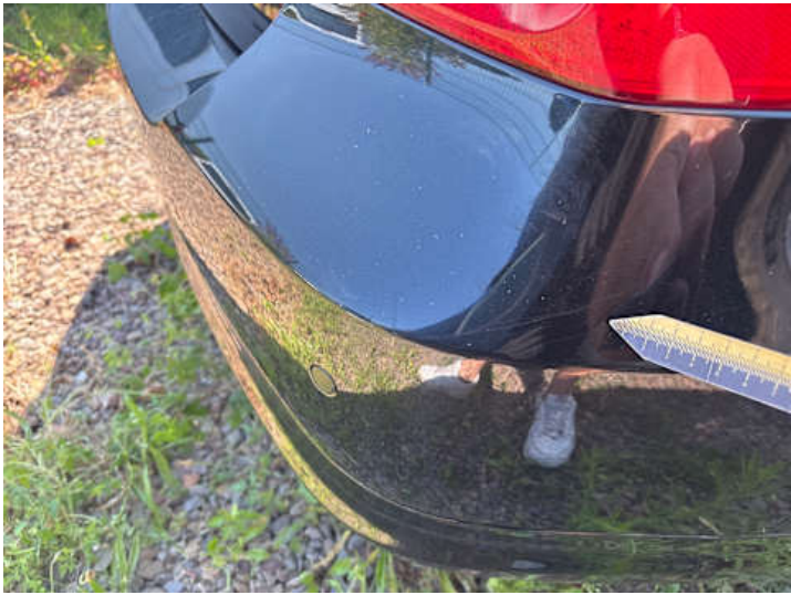
Stoßstange hinten (Kratzer, Lackschaden)
