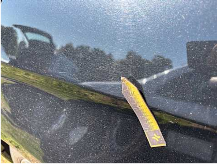
Seitenteil hinten links (Kratzer)
