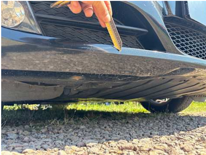
Stoßstange vorne (Lackschaden)
