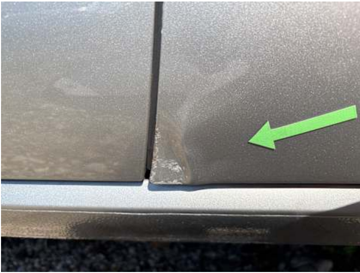
Beifahrertür (Verformung, Kratzer)
