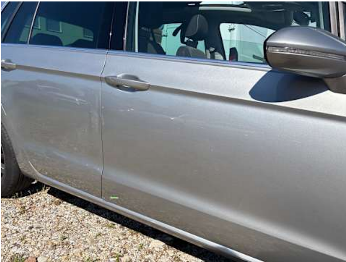
Beifahrertür (Verformung, Kratzer)
