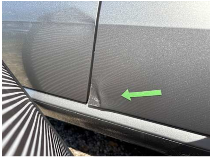
Beifahrertür (Verformung, Kratzer)
