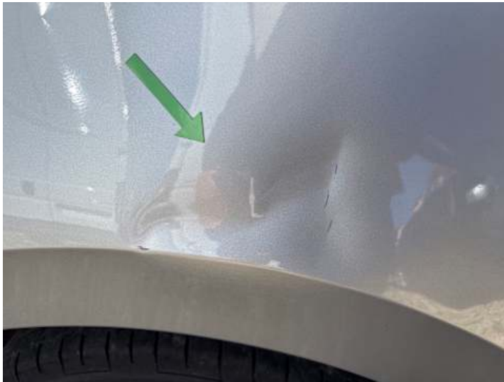
Seitenteil hinten links (Verformung, Kratzer)
