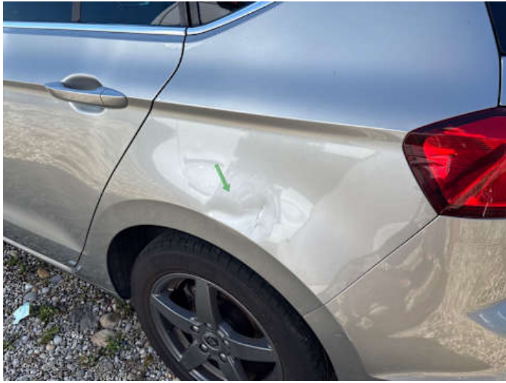
Seitenteil hinten links (Verformung, Kratzer)
