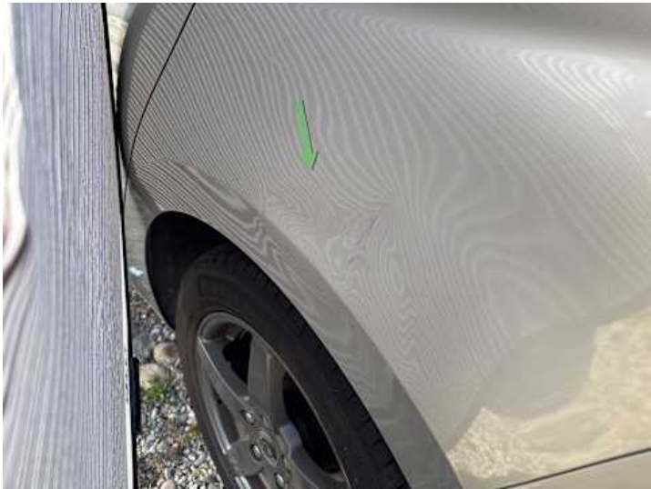
Seitenteil hinten links (Verformung, Kratzer)
