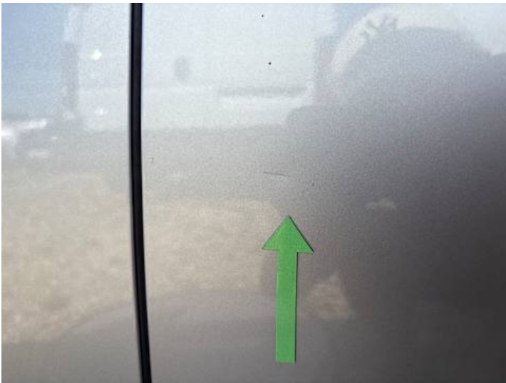
Türe hinten links (Kratzer, Delle)
