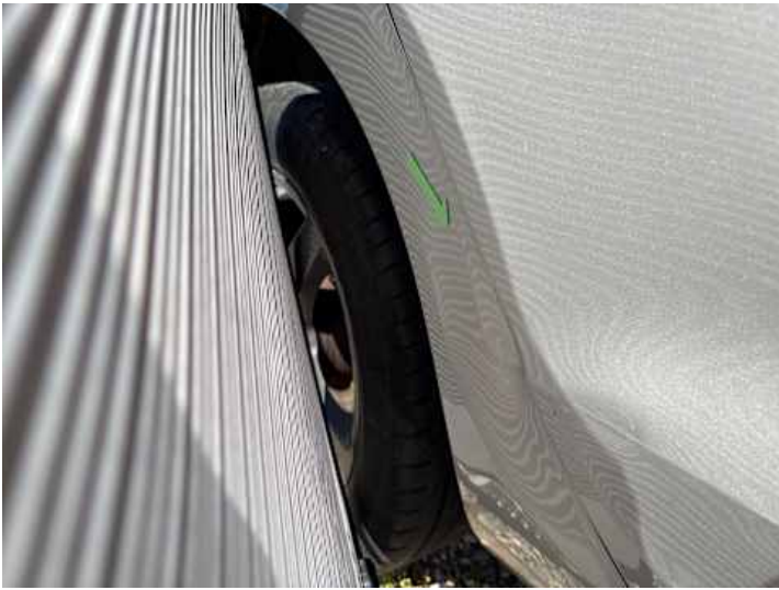
Seitenteil hinten rechts (Delle, Kratzer)
