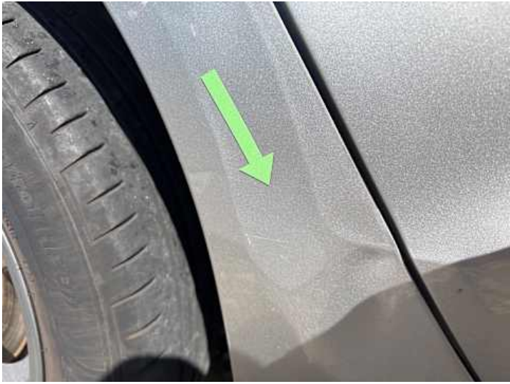
Seitenteil hinten rechts (Delle, Kratzer)
