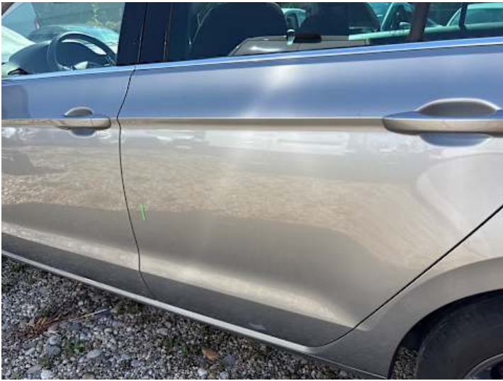
Türe hinten links (Kratzer, Delle)
