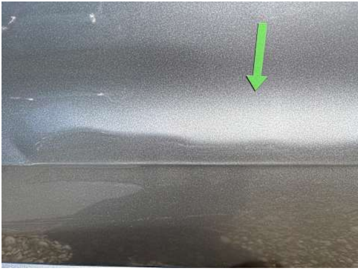
Türe hinten rechts (Verformung, Kratzer)
