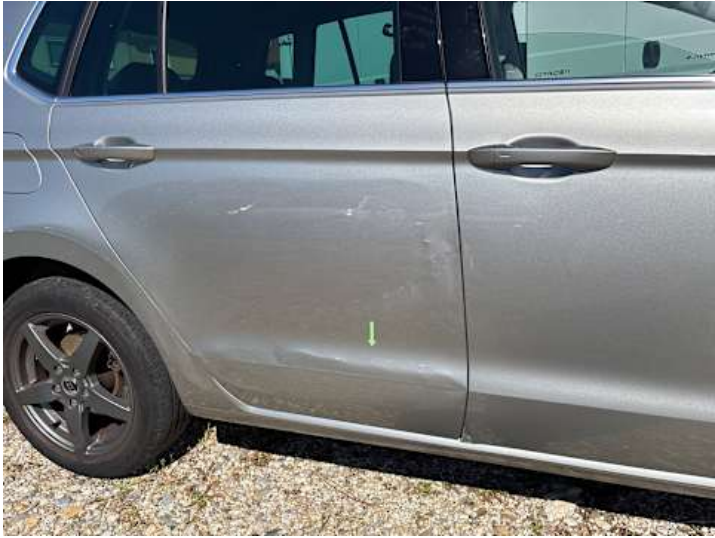
Türe hinten rechts (Verformung, Kratzer)
