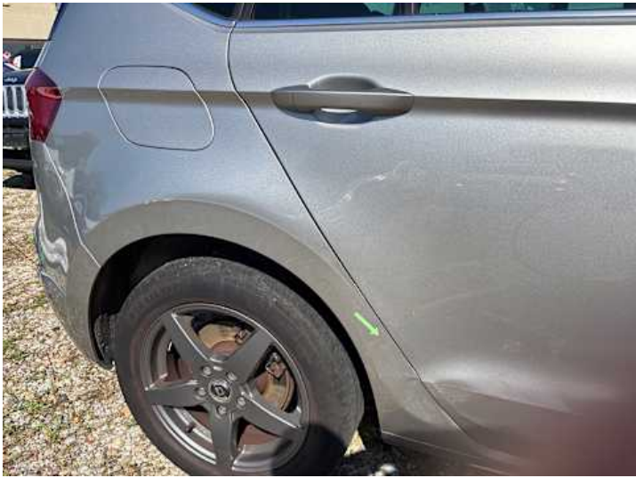
Seitenteil hinten rechts (Delle, Kratzer)
