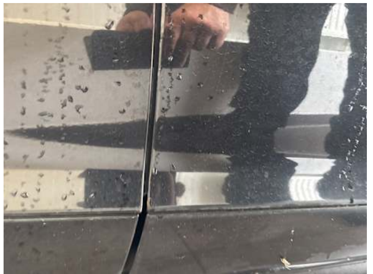
Beifahrtür (Rost, Lackschaden)
