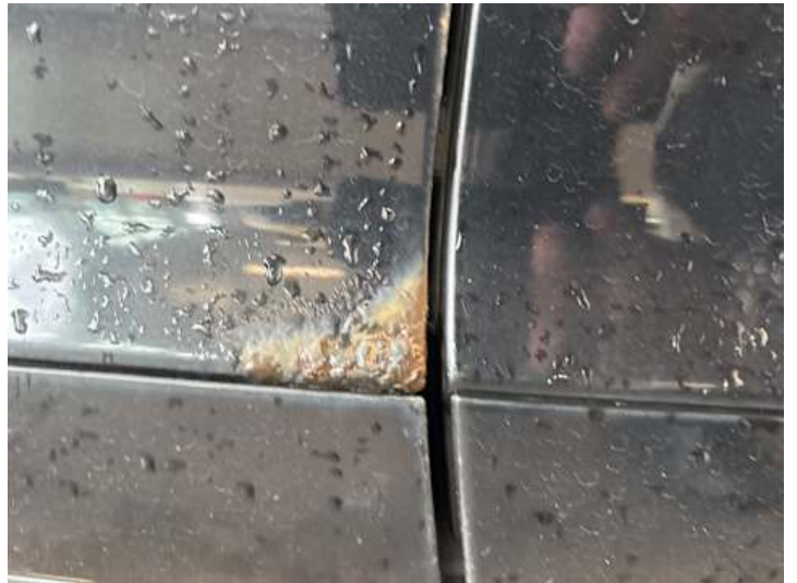
Fahrtür (Rost, Lackschaden)
