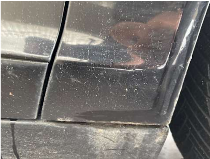
Kotflügel vorne rechts (Lackschaden, Rost)
