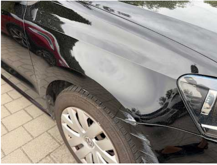
Kotflügel vorne rechts (Kratzer, Verformung)
