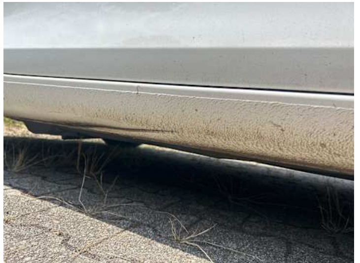
Schweller rechts (Kratzer, Verformung)
