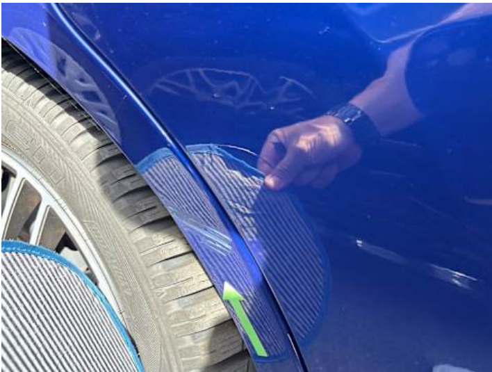
Seitenteil hinten rechts (Kratzer, Lackschaden, Delle)
