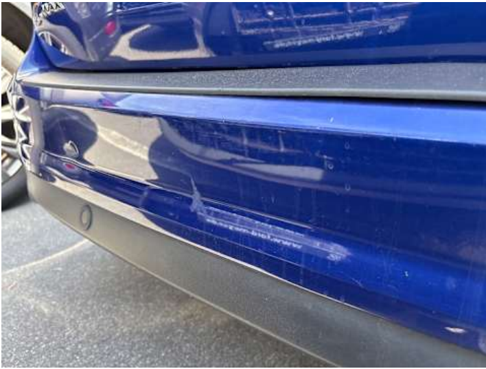
Stoßstange hinten (Spaltmaße ungenau, Kratzer, Lackschaden)
