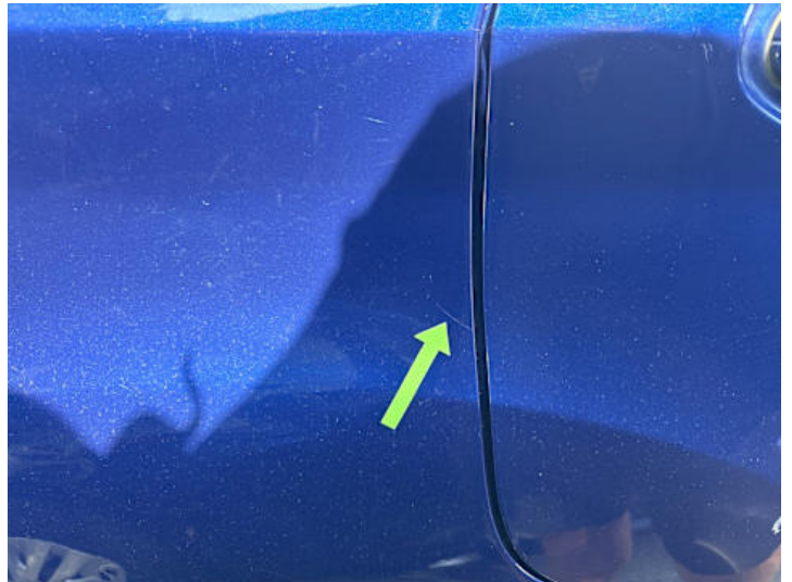
Seitenteil hinten rechts (Kratzer, Lackschaden, Delle)
