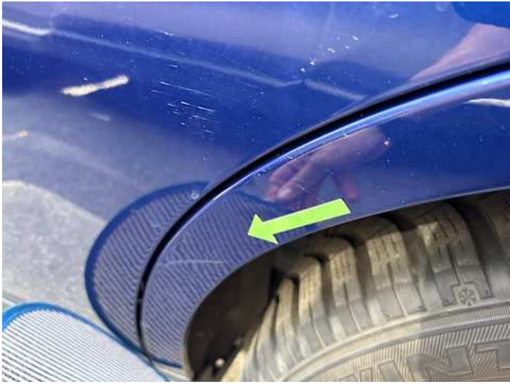
Seitenteil hinten links (Lackschaden, Kratzer, Delle)
