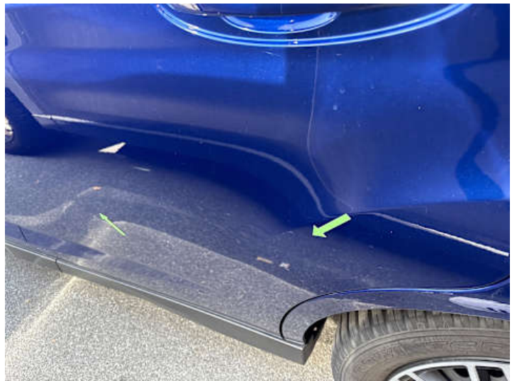
Türe hinten links (Kratzer, Delle)
