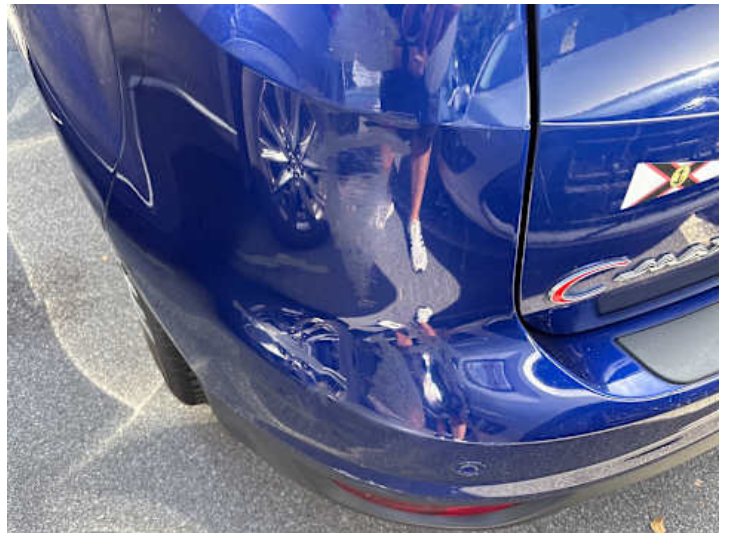
Stoßstange hinten (Spaltmaße ungenau, Kratzer, Lackschaden)
