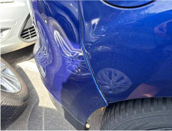
Stoßstange hinten (Spaltmaße ungenau, Kratzer, Lackschaden)
