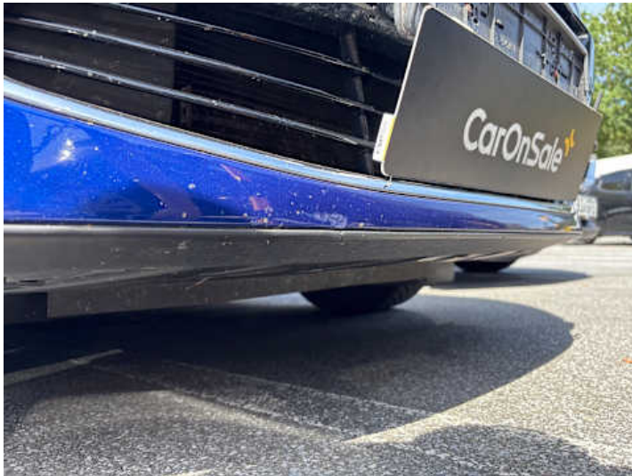
Stoßstange vorne (Kratzer, Lackschaden)
