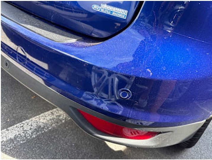
Stoßstange hinten (Spaltmaße ungenau, Kratzer, Lackschaden)
