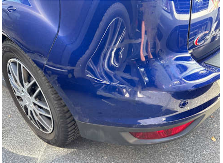
Stoßstange hinten (Spaltmaße ungenau, Kratzer, Lackschaden)
