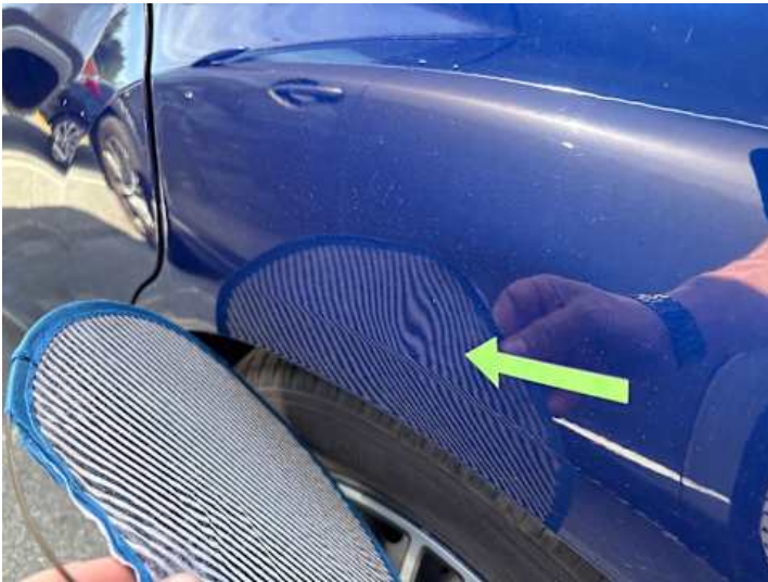
Seitenteil hinten links (Lackschaden, Kratzer, Delle)
