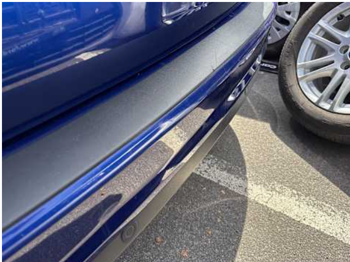
Stoßstange hinten (Spaltmaße ungenau, Kratzer, Lackschaden)
