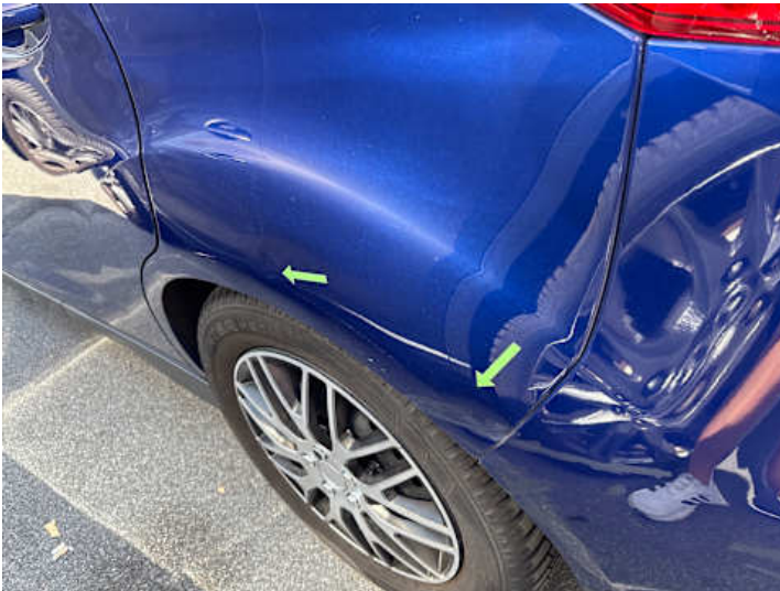
Seitenteil hinten links (Lackschaden, Kratzer, Delle)
