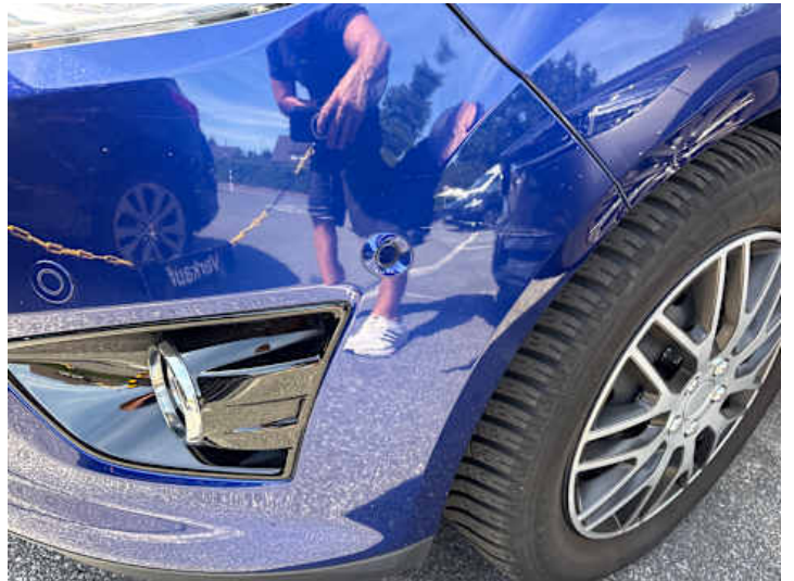
Stoßstange vorne (Kratzer, Lackschaden)
