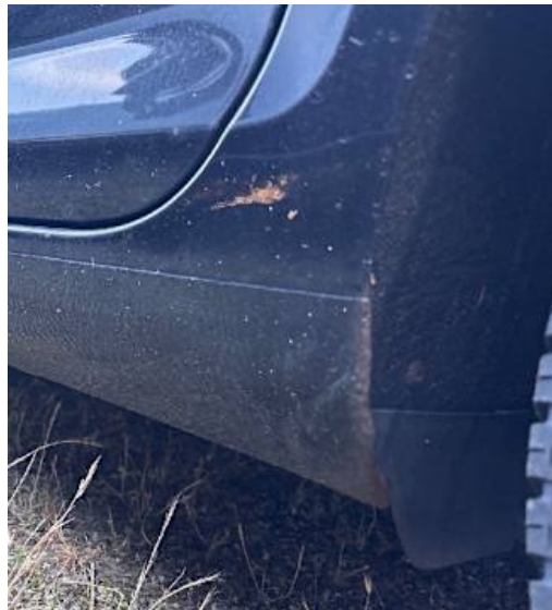
Schweller links (Rost)
