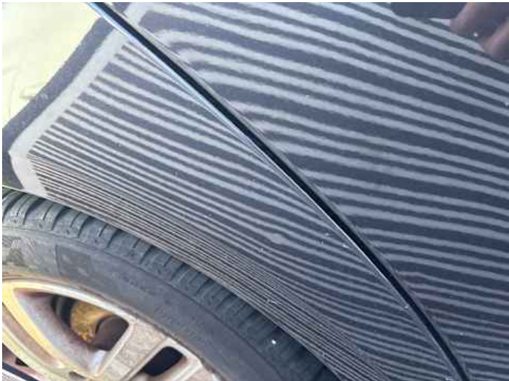
Seitenteil hinten rechts (Delle)
