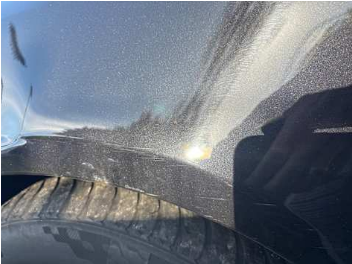
Kotflügel vorne links (Rost)
