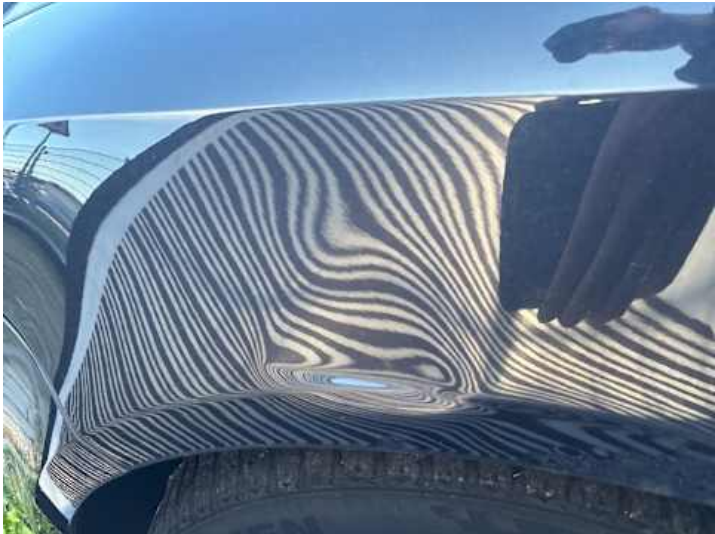
Kotflügel vorne links (Verformung)
