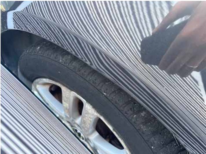
Kotflügel vorne rechts (Verformung)
