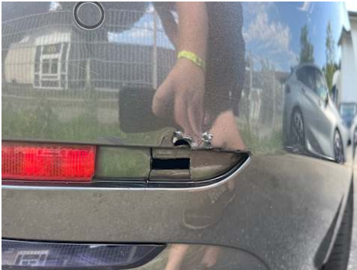
Stoßstange hinten (Riss/Bruch)
