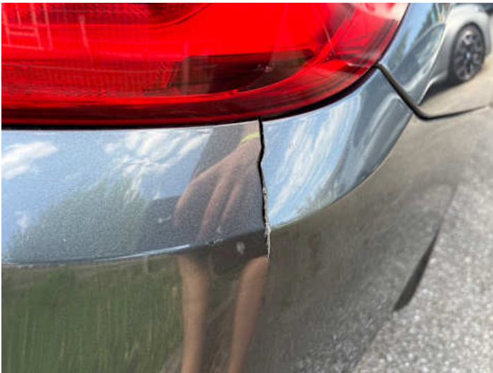
Stoßstange hinten (Riss/Bruch)
