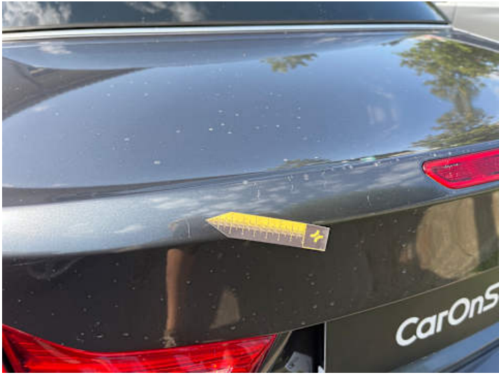
Heckklappe (Kratzer, Lackschaden)
