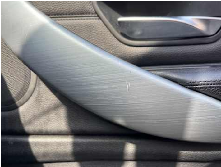
Innenraum (Kratzer, Diverse Schäden)
