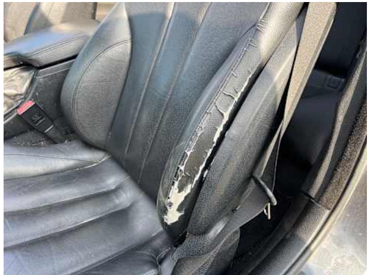
Innenraum (Diverse Schäden, Verschmutzung, Riss/Bruch)
