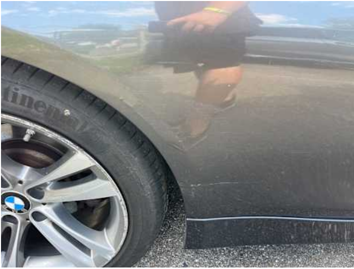
Seitenteil hinten rechts (Kratzer, Lackschaden, Verformung)
