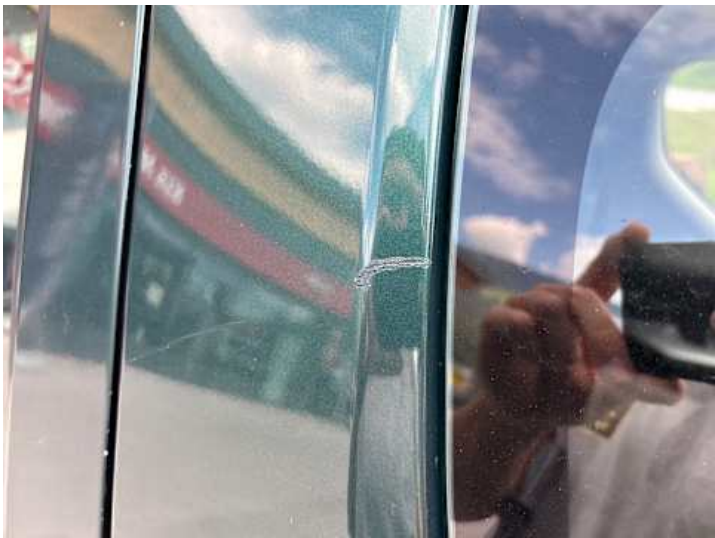
Seitenteil hinten links (Kratzer, Unsachgemäß instand gesetzt)
