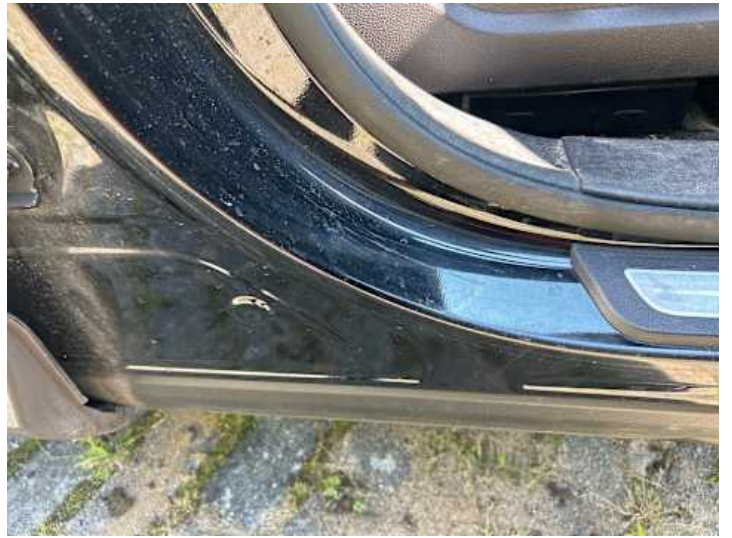
Schweller rechts (Kratzer, Delle)
