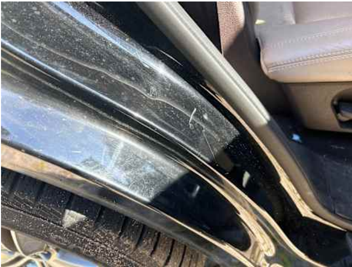
Schweller rechts (Kratzer, Delle)
