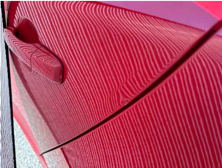
Türe hinten links (Delle, Lackschaden)
