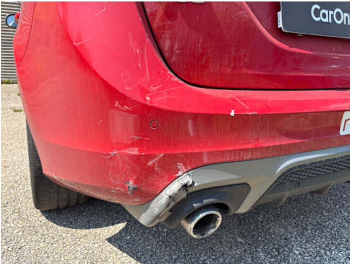
Stoßstange hinten (Kratzer, Riss/Bruch, Verformung)
