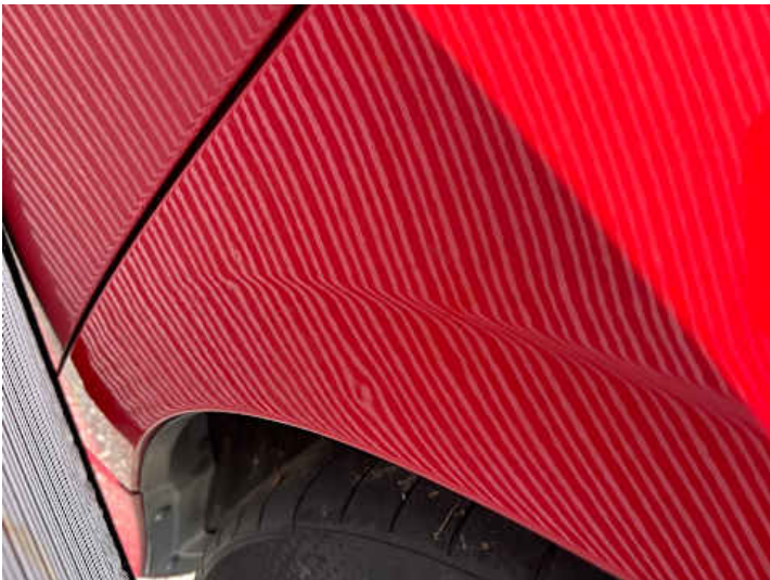
Seitenteil hinten links (Delle)
