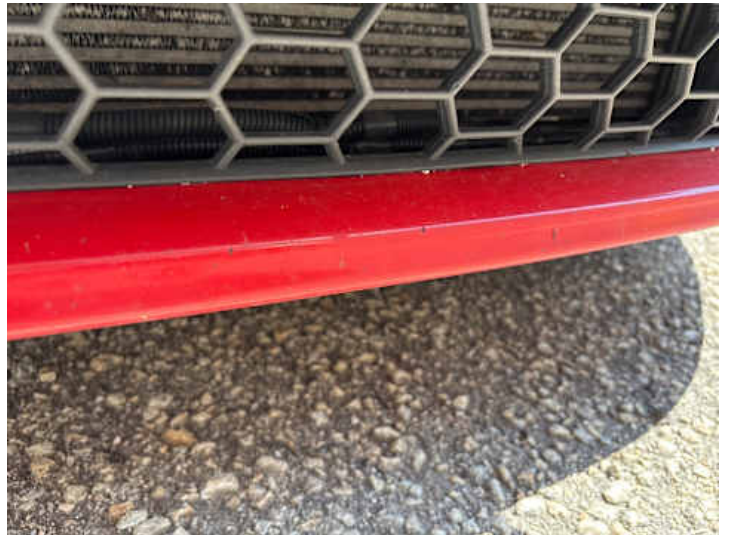
Stoßstange vorne (Lackschaden, Steinschlag)
