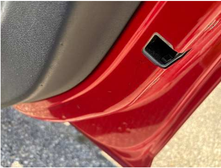
Beifahrertür (Delle, Lackschaden)
