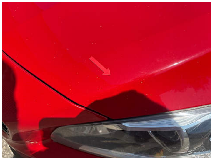
Motorhaube (Lackschaden, Steinschlag)
