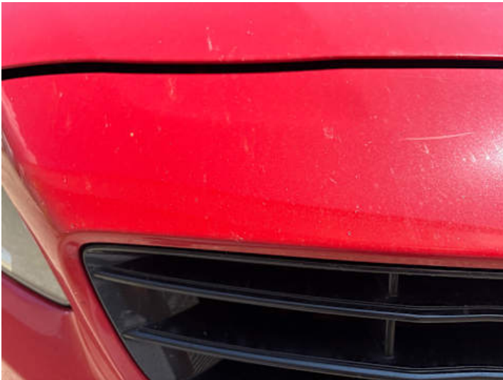
Stoßstange vorne (Lackschaden, Steinschlag)
