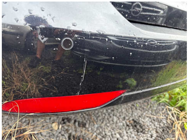
Stoßstange hinten (Lackschaden, Kratzer)
