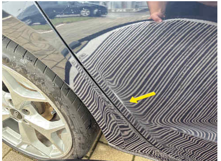
Türe hinten rechts (Verformung, Kratzer, Lackschaden)
