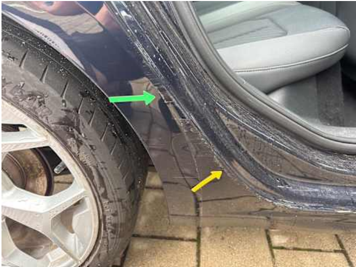
Seitenteil hinten rechts (Verformung, Kratzer, Lackschaden)
