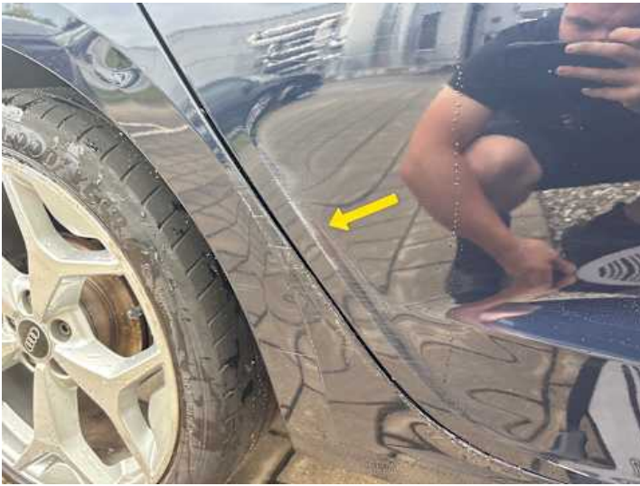
Türe hinten rechts (Verformung, Kratzer, Lackschaden)
