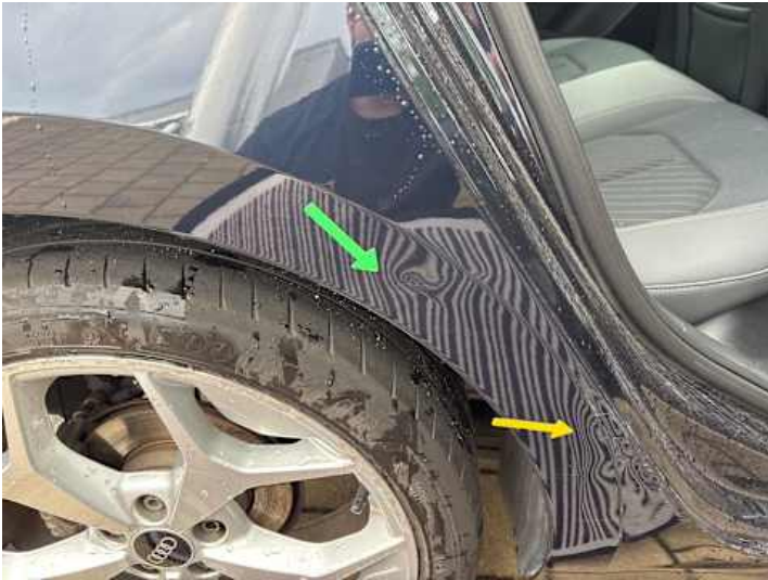
Seitenteil hinten rechts (Verformung, Kratzer, Lackschaden)
