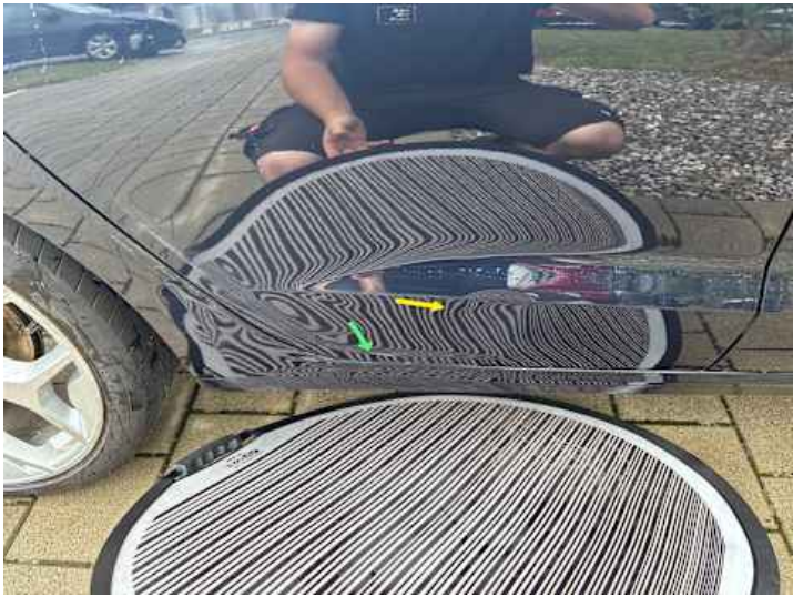
Türe hinten rechts (Verformung, Kratzer, Lackschaden)
