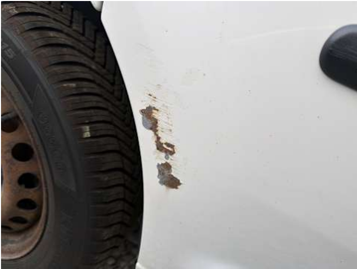
Türe hinten rechts (Kratzer, Rost)
