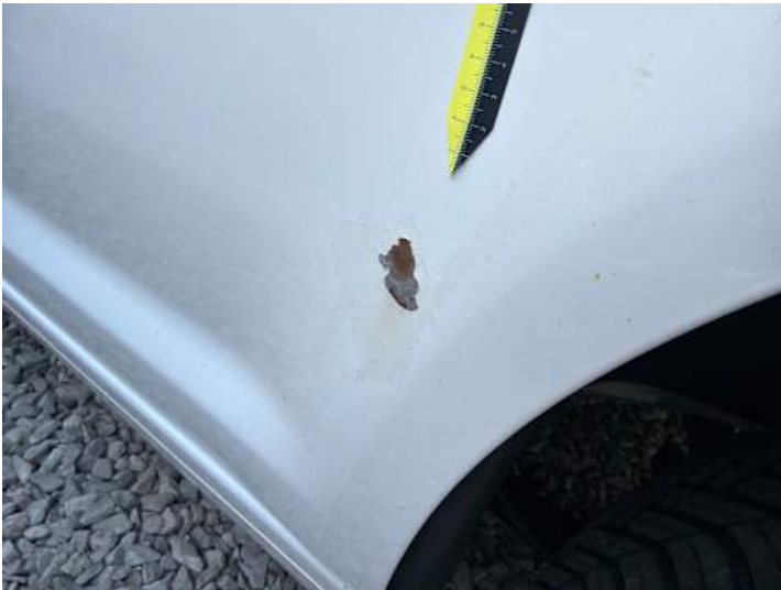
Türe hinten links (Unsachgemäß instand gesetzt, Rost)
