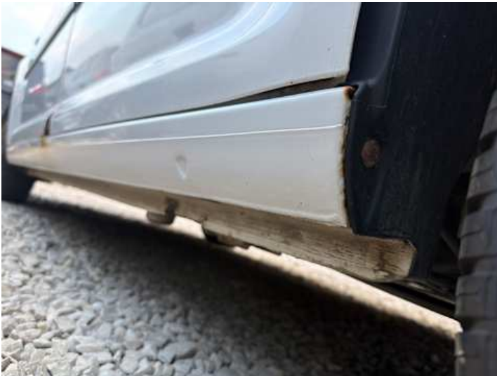
Schweller links (Rost)
