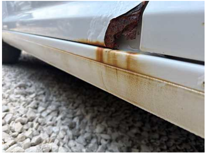
Schweller links (Rost)
