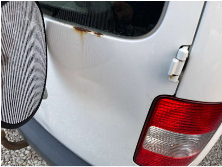
Heckklappe (Rost, Verformung)
