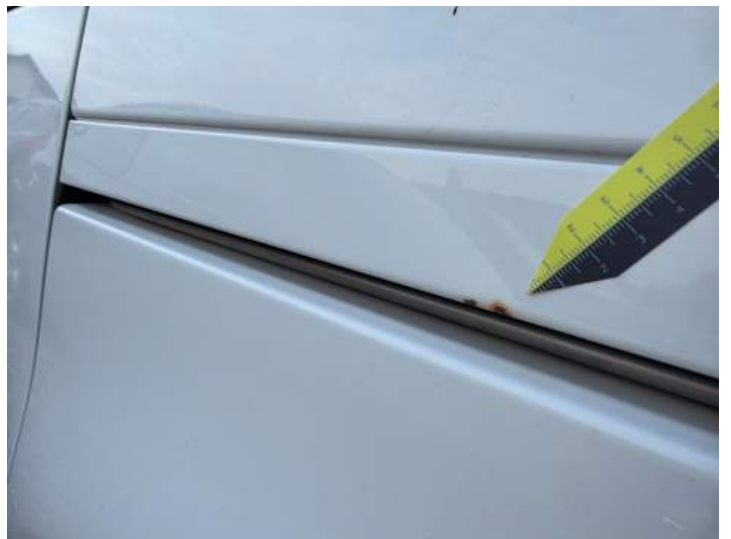
Seitenteil hinten links (Rost)
