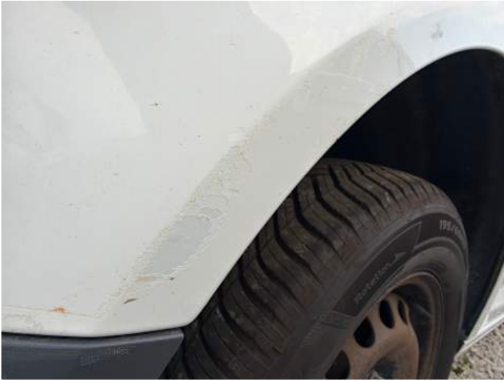
Seitenteil hinten rechts (Rost, Kratzer, Unsachgemäß instand gesetzt)
