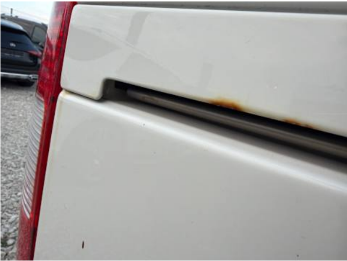
Seitenteil hinten rechts (Rost)
