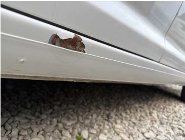
Schweller rechts (Rost)
