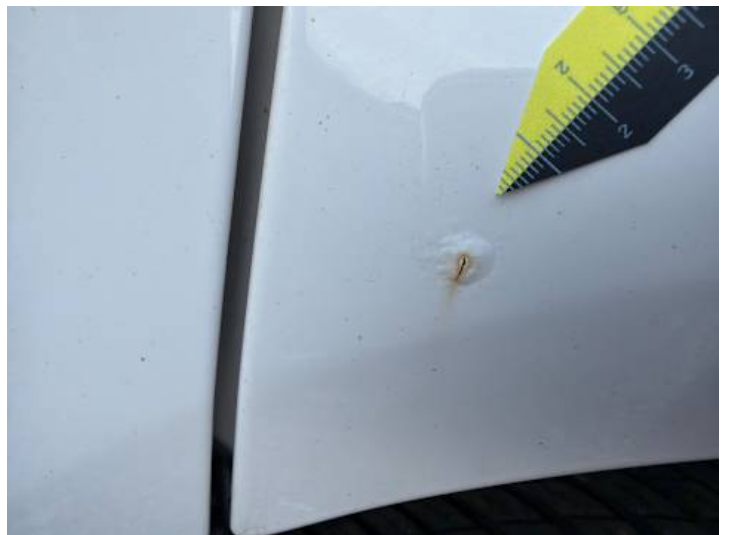
Seitenteil hinten links (Rost)
