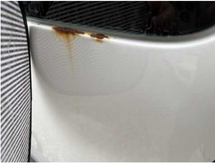
Heckklappe (Rost, Verformung)
