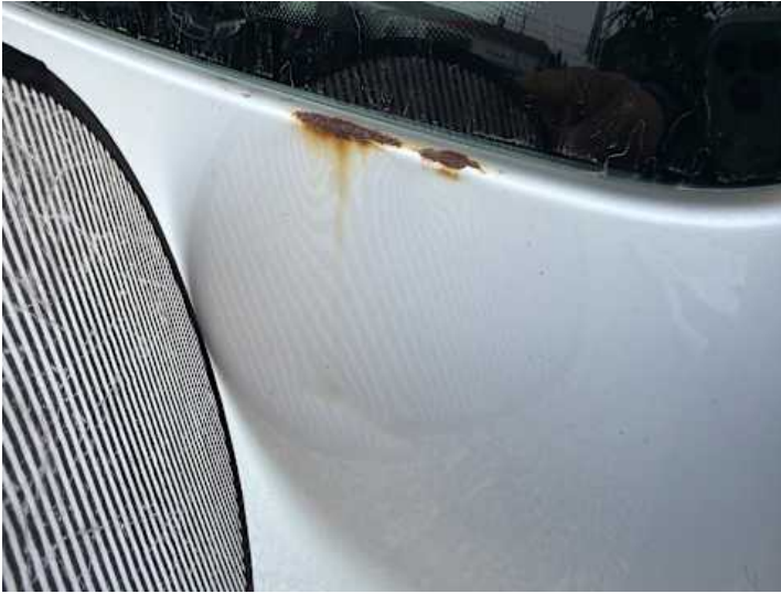
Heckklappe (Rost, Verformung)
