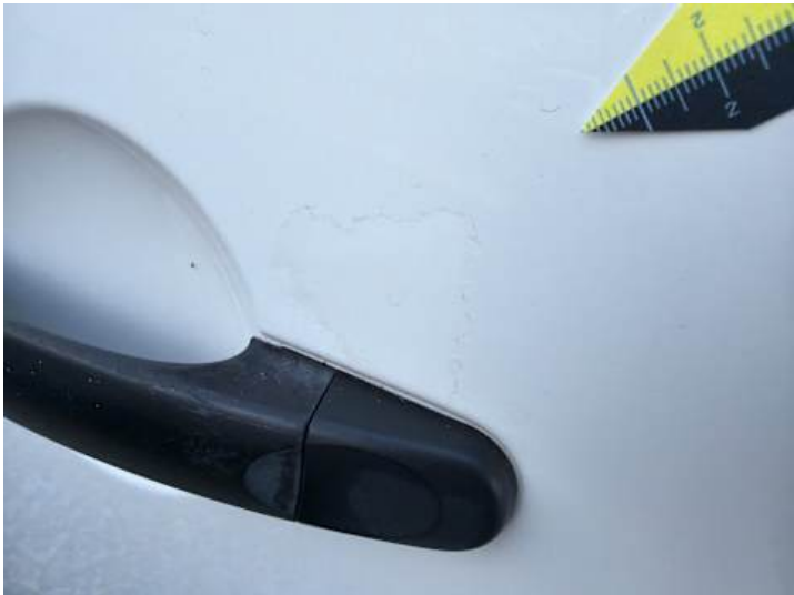
Türe hinten links (Lackschaden)
