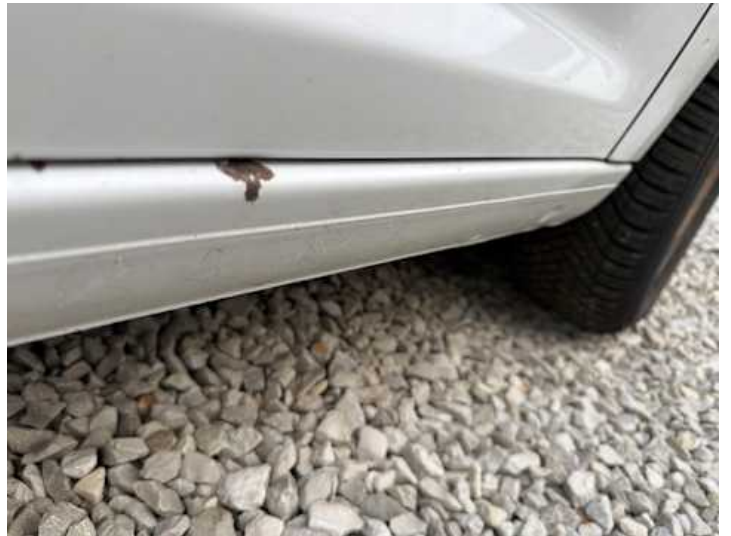
Schweller rechts (Rost)
