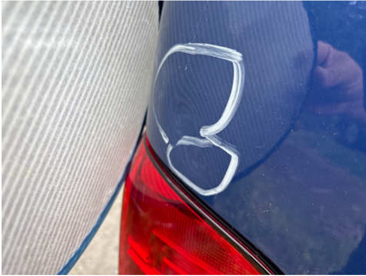
Heckklappe (Verformung, Delle, Riss/Bruch)
