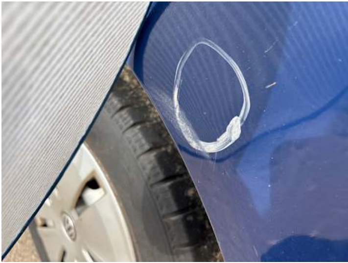
Seitenteil hinten rechts (Delle, Lackschaden)
