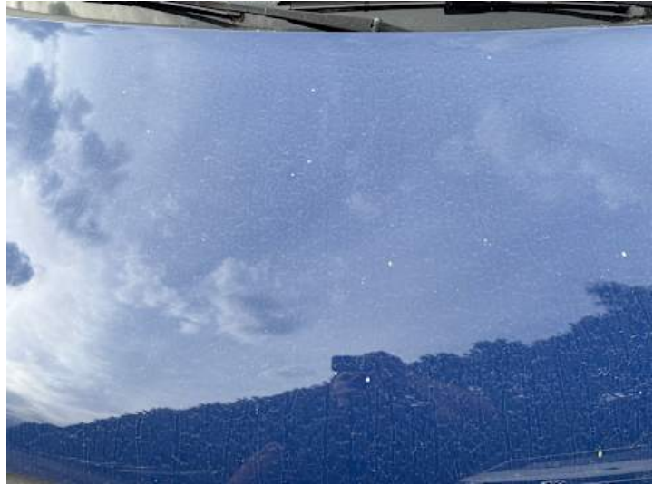
Motorhaube (Steinschlag, Lackschaden)
