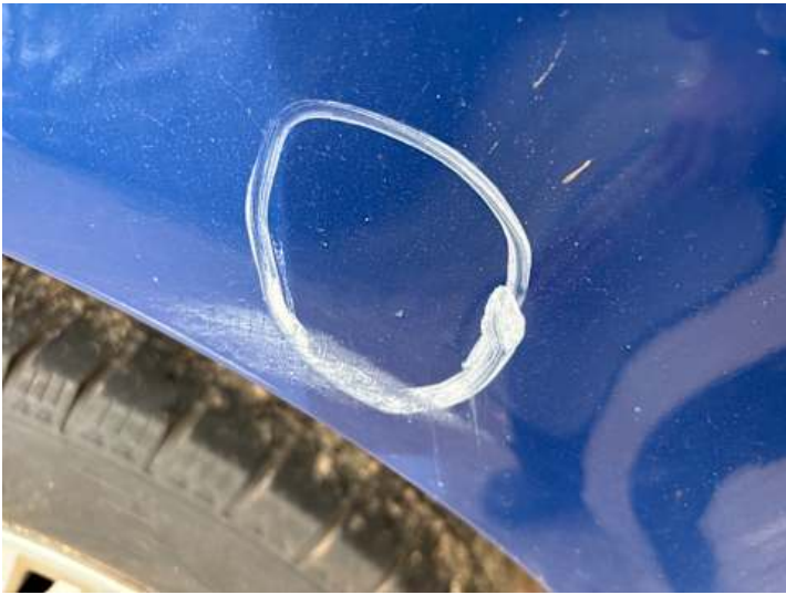
Seitenteil hinten rechts (Delle, Lackschaden)
