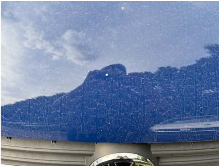
Motorhaube (Steinschlag, Lackschaden)
