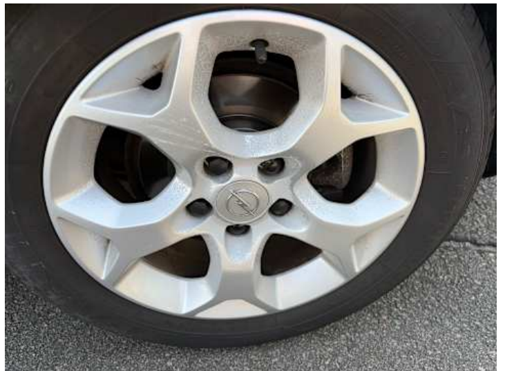
Rad (Anderer Schaden, Kratzer): Lackschaden.
