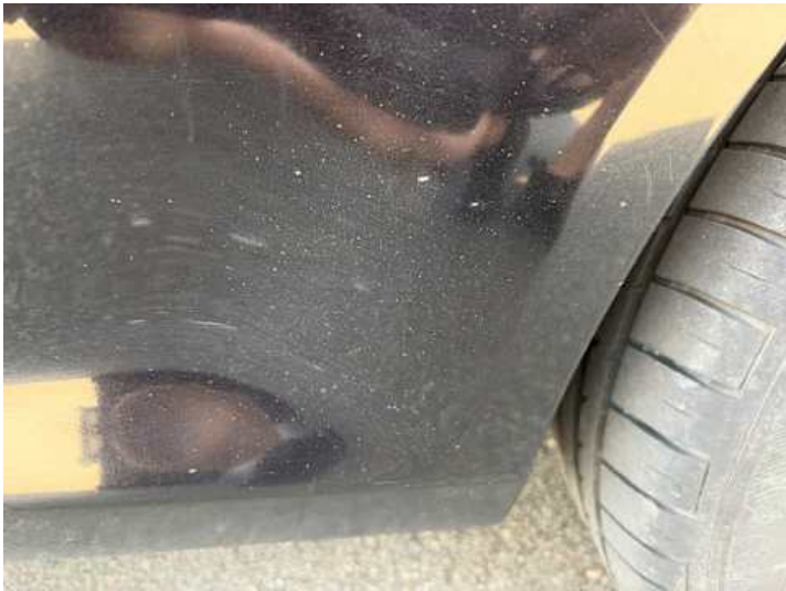
Seitenteil hinten links (Steinschlag)
