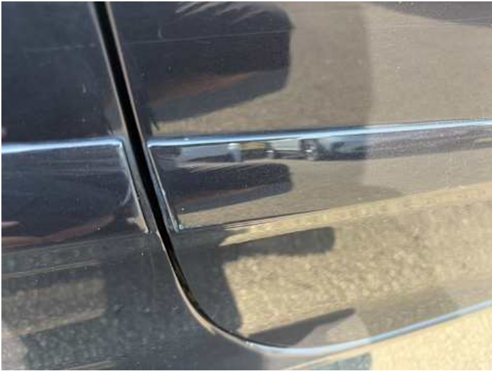
Beifahrtür (Kratzer, Lackschaden)
