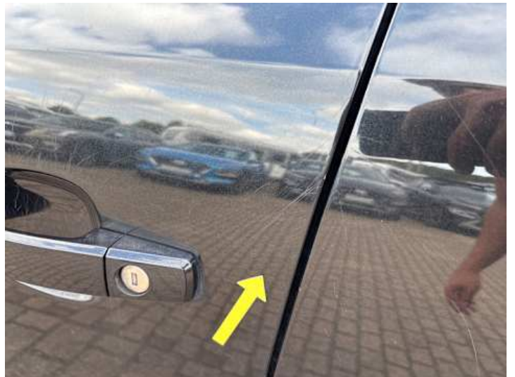
Fahrtür (Kratzer, Delle)
