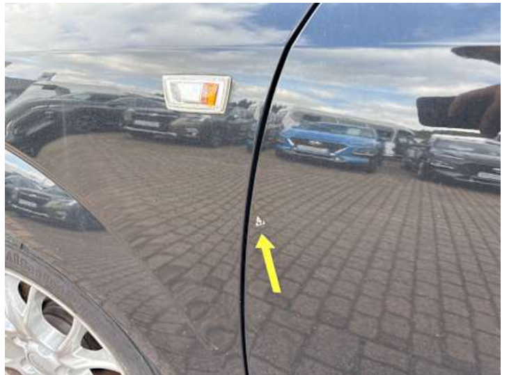
Fahrtür (Kratzer, Delle)
