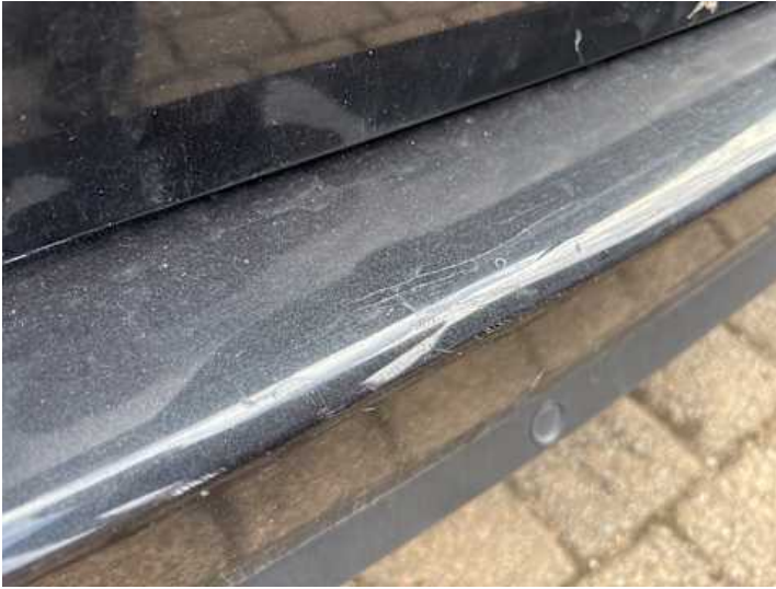
Stoßstange hinten (Kratzer, Lackschaden, Verformung)
