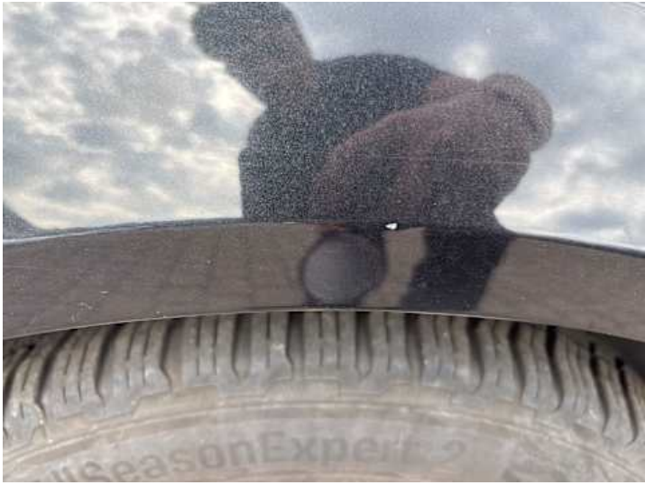
Kotflügel vorne rechts (Kratzer)
