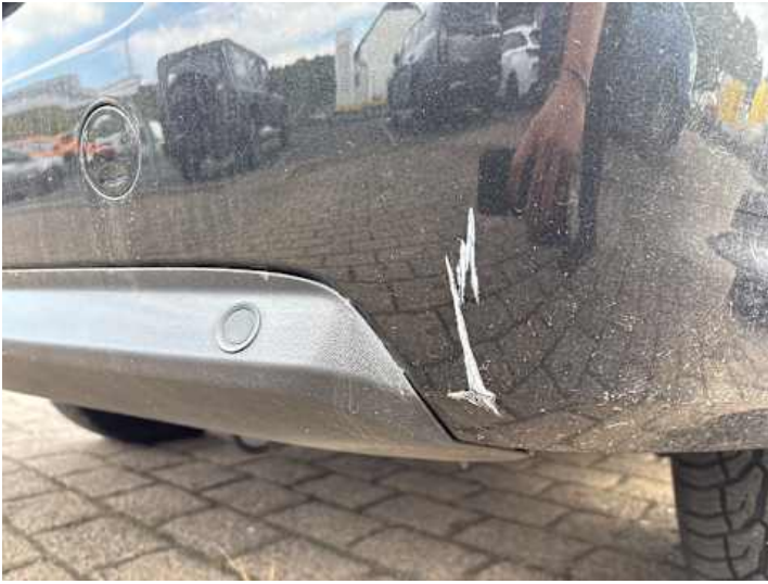
Stoßstange hinten (Kratzer, Lackschaden, Verformung)
