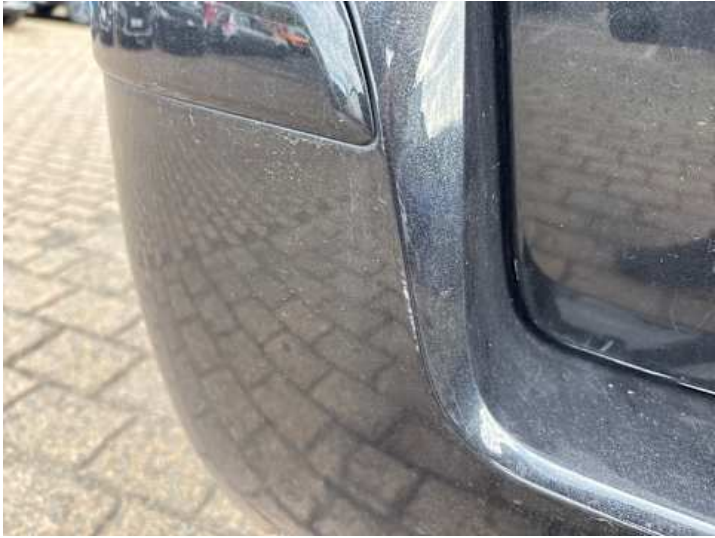
Stoßstange hinten (Kratzer, Lackschaden, Verformung)
