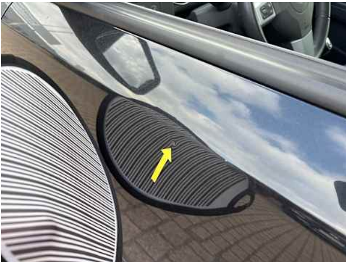
Fahrtür (Kratzer, Delle)
