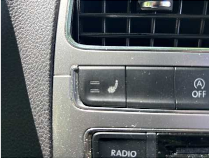
Innenraum (Anderer Schaden, Ohne Funktion): Sitzheizung Fahrer ohne Funktion
