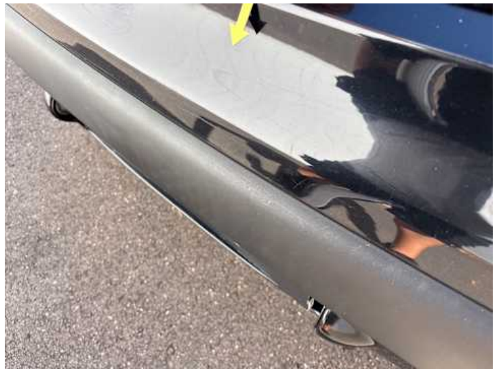
Stoßstange hinten (Lackschaden, Kratzer)
