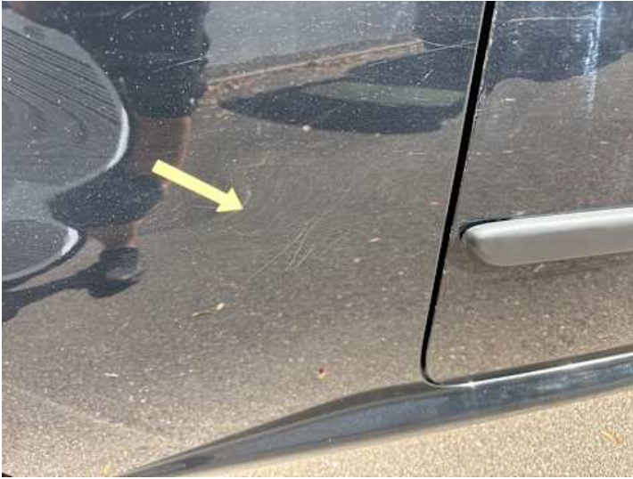
Seitenteil hinten rechts (Lackschaden, Kratzer)
