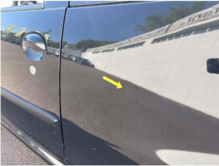
Seitenteil hinten links (Lackschaden, Delle)
