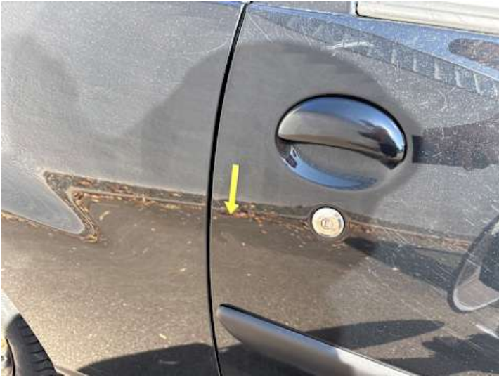
Beifahrertür (Lackschaden, Delle)
