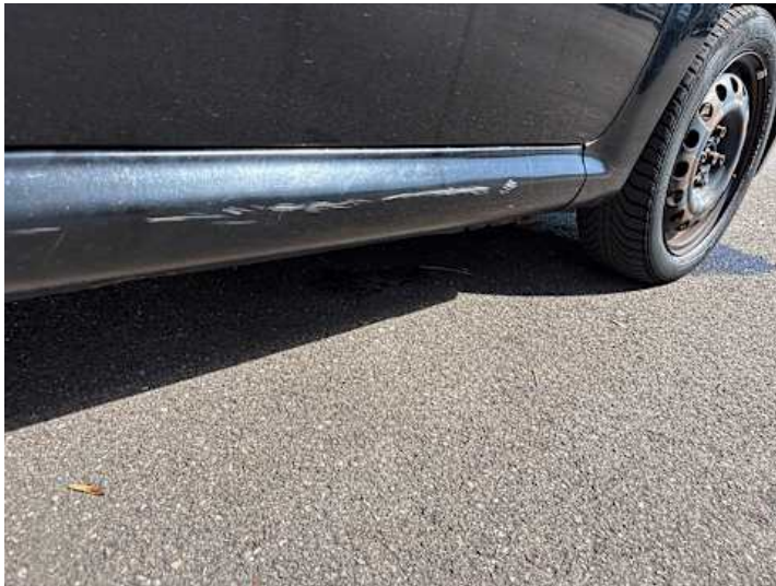
Schweller rechts (Lackschaden)
