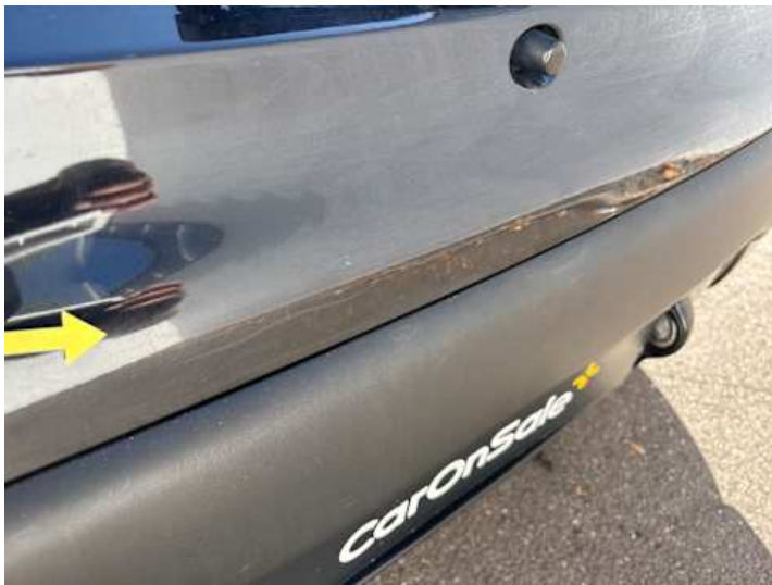
Stoßstange hinten (Lackschaden, Kratzer)
