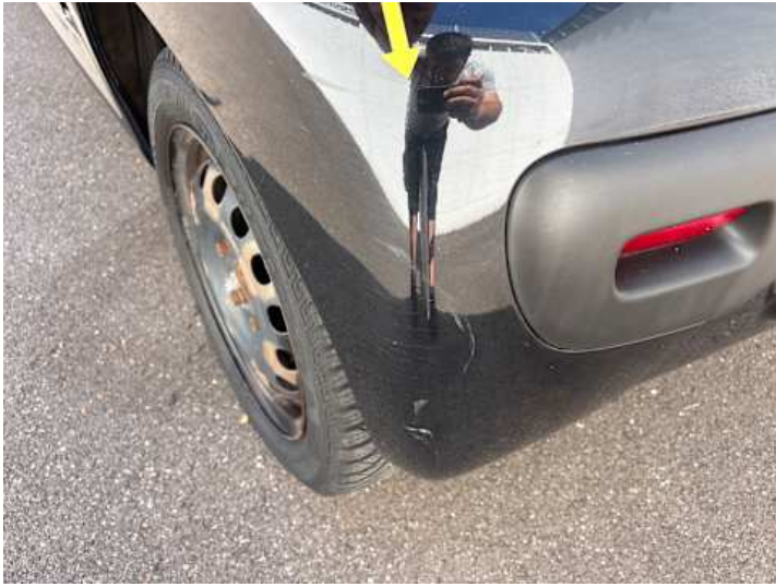
Stoßstange hinten (Lackschaden, Kratzer)
