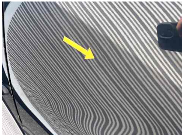
Seitenteil hinten links (Lackschaden, Delle)
