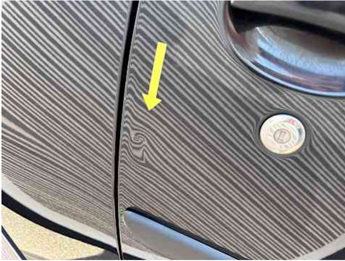
Beifahrertür (Lackschaden, Delle)
