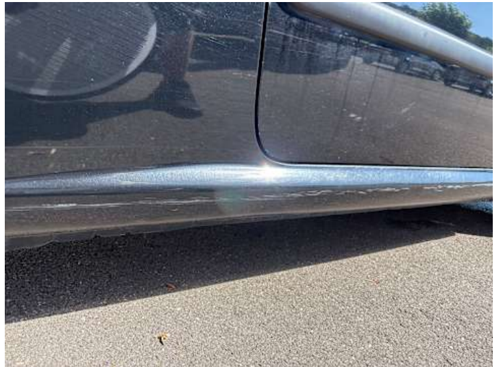
Schweller rechts (Lackschaden)
