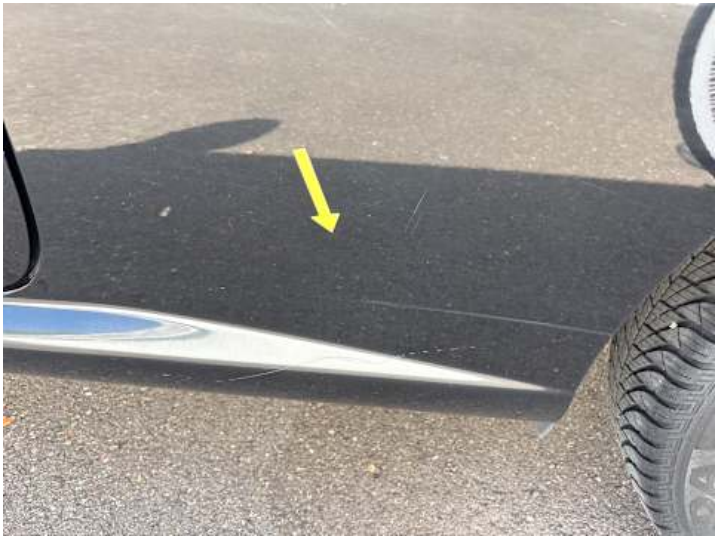
Seitenteil hinten links (Lackschaden, Kratzer)
