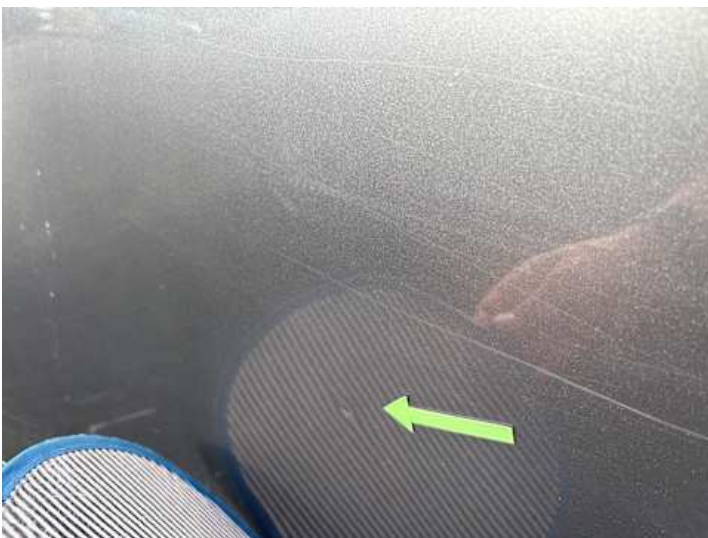
Fahrtür (Kratzer, Delle)
