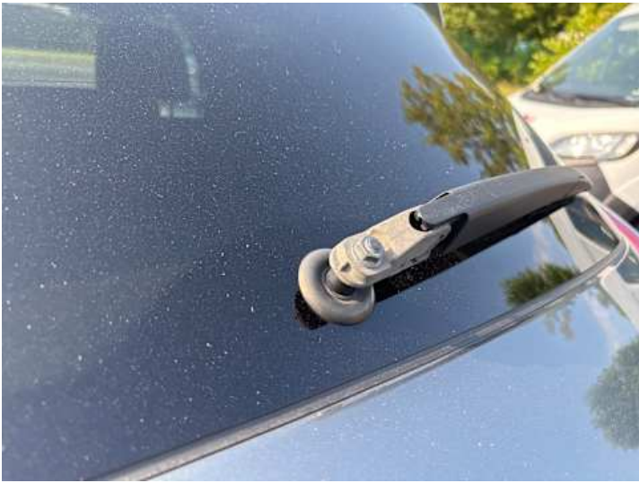
Heckklappe (Anderer Schaden): Abdeckung fehlt
