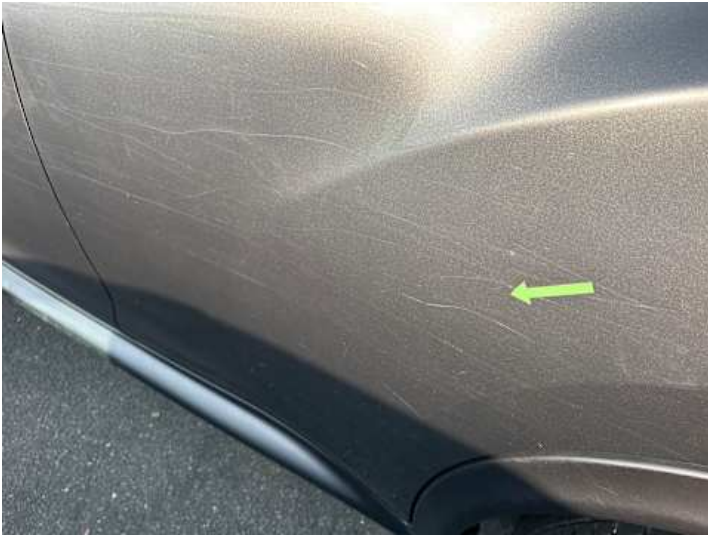
Türe hinten links (Kratzer)
