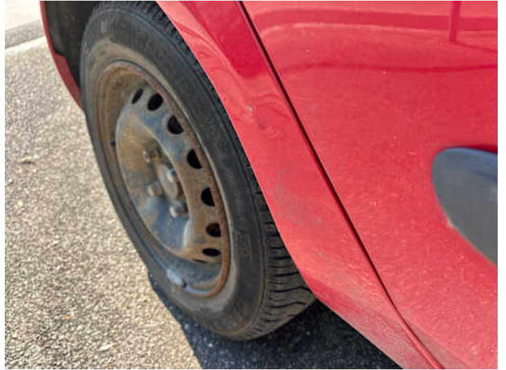
Seitenteil hinten rechts (Verformung, Delle)
