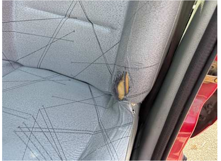
Innenraum (Verschleiß, Riss/Bruch)
