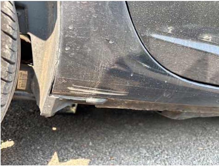
Schweller rechts (Lackschaden)
