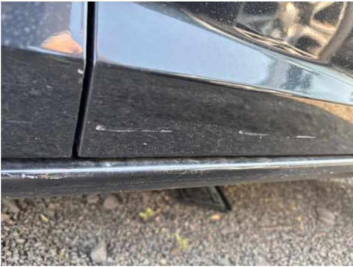
Türe hinten links (Lackschaden)
