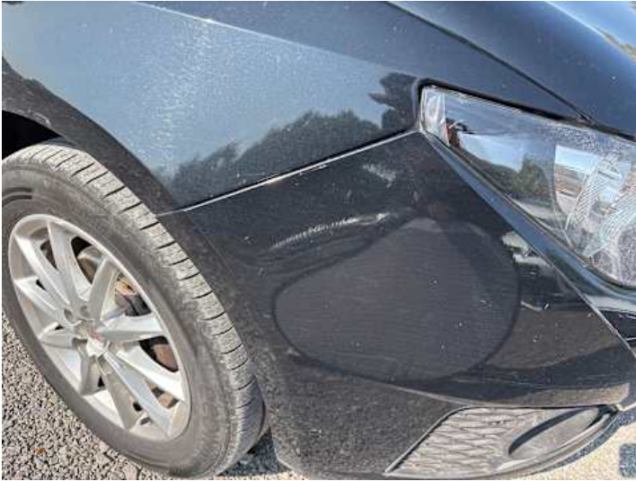
Stoßstange vorne (Spaltmaße ungenau)
