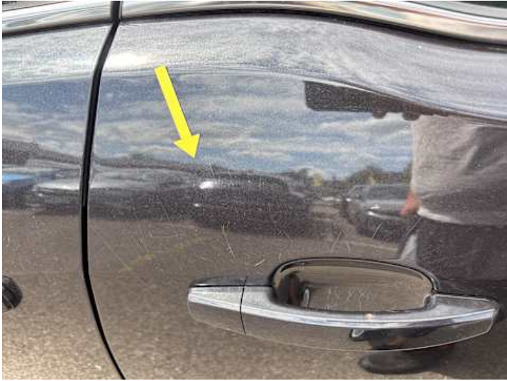
Türe hinten links (Lackschaden, Kratzer)
