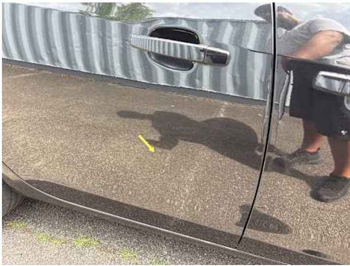
Türe hinten rechts (Verformung, Lackschaden)
