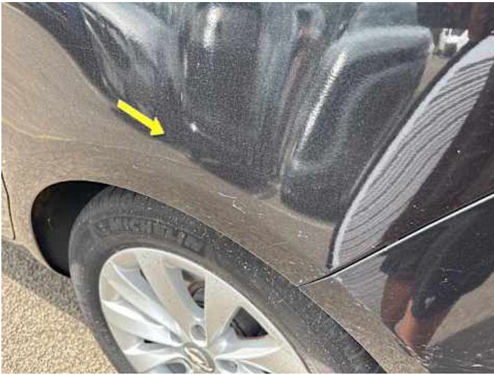
Seitenteil hinten links (Lackschaden)
