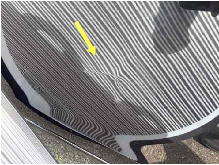
Türe hinten rechts (Verformung, Lackschaden)
