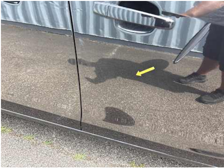
Beifahrertür (Verformung, Spaltmaße ungenau)
