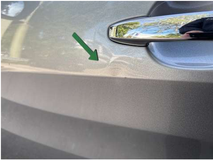
Fahrtür (Delle, Kratzer)
