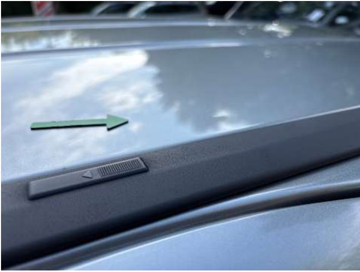
Dach (Steinschlag, Delle)
