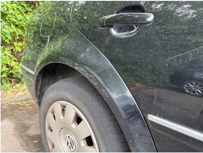
Seitenteil hinten rechts (Kratzer, Lackschaden, Unsachgemäß instand gesetzt)
