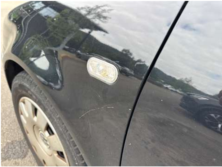
Kotflügel vorne links (Lackschaden, Kratzer)
