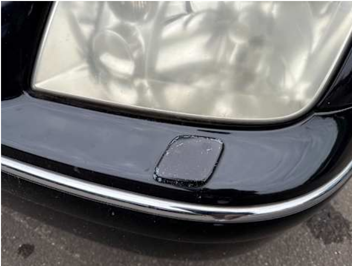
Stoßstange vorne (Lackschaden, Kratzer, Unsachgemäß instand gesetzt, Riss/Bruch)
