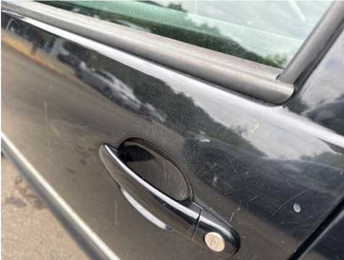
Fahrtür (Kratzer, Lackschaden, Riss/Bruch)
