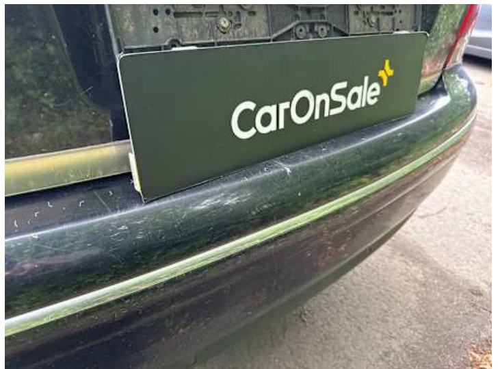
Stoßstange hinten (Lackschaden, Kratzer)
