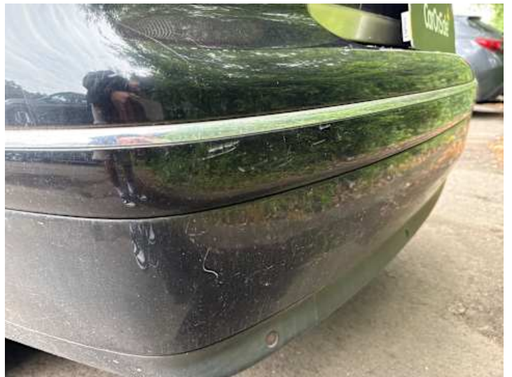
Stoßstange hinten (Lackschaden, Kratzer)
