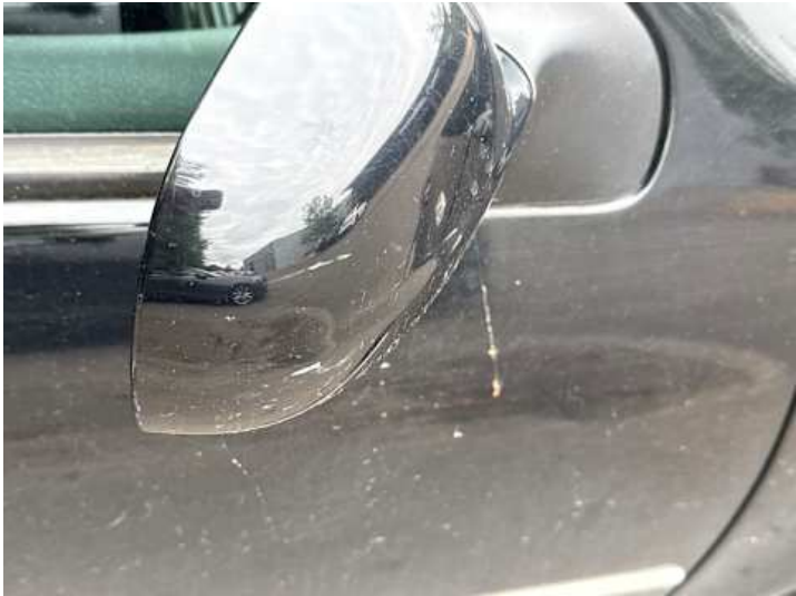
Beifahrtür (Kratzer, Lackschaden)
