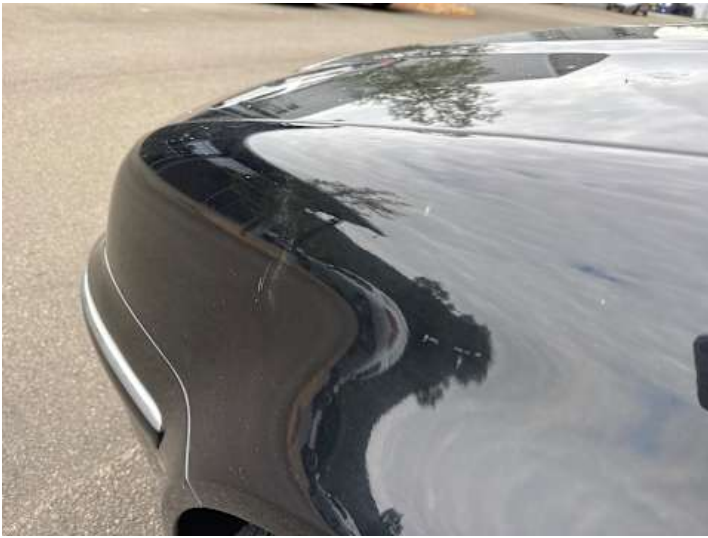
Kotflügel vorne links (Lackschaden, Kratzer)
