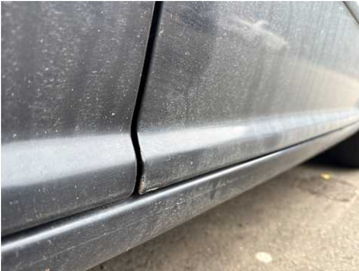
Beifahrtür (Lackschaden, Rost)
