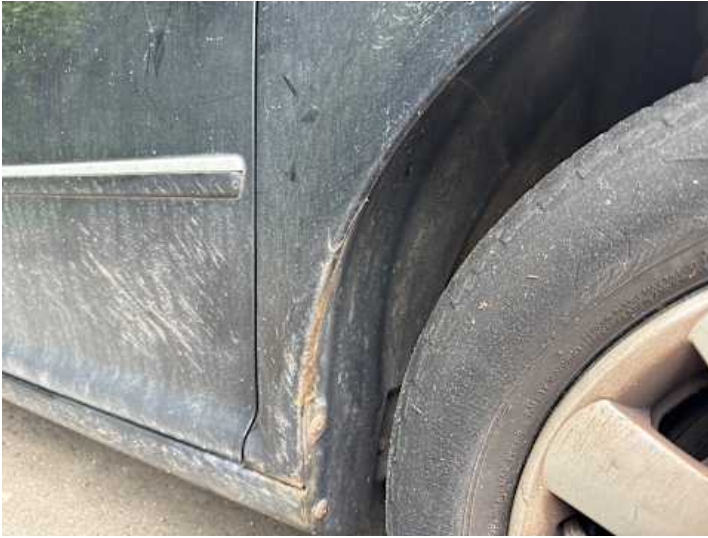
Kotflügel vorne rechts (Rost, Lackschaden)
