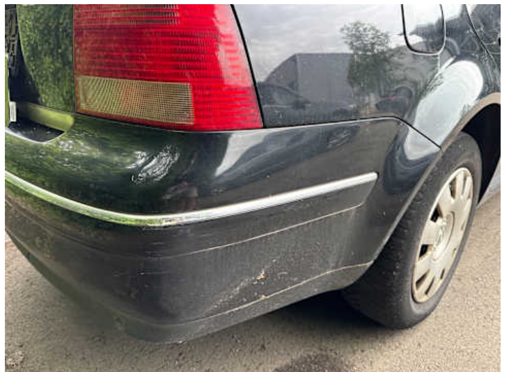
Stoßstange hinten (Lackschaden, Kratzer)
