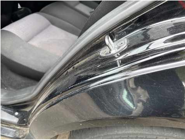
Seitenteil hinten links (Lackschaden, Kratzer)
